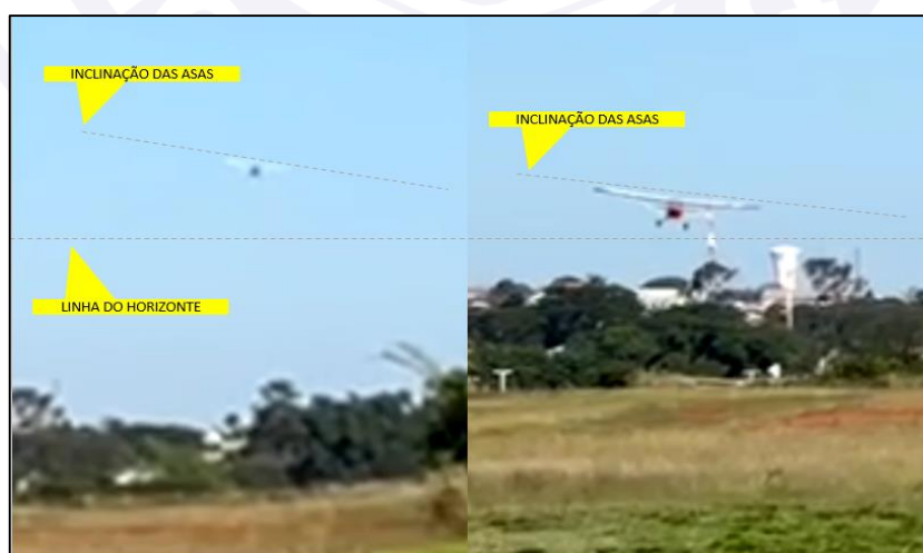
Figura 3 - No detalhe, as correções da aeronave para manter o alinhamento com eixo da pista. A aeronave manteve a asa esquerda “baixa” durante toda a aproximação final.
