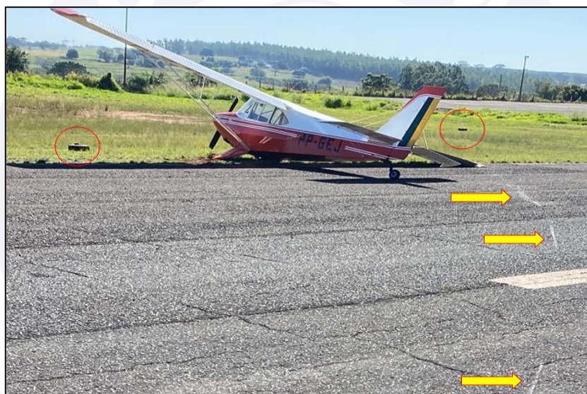
Figura 1 - Em destaque nos dois círculos vermelhos a posição de parada das rodas do trem de pouso principal. As setas amarelas evidenciam as marcas deixadas no asfalto pelo contato com a asa direita da aeronave.
