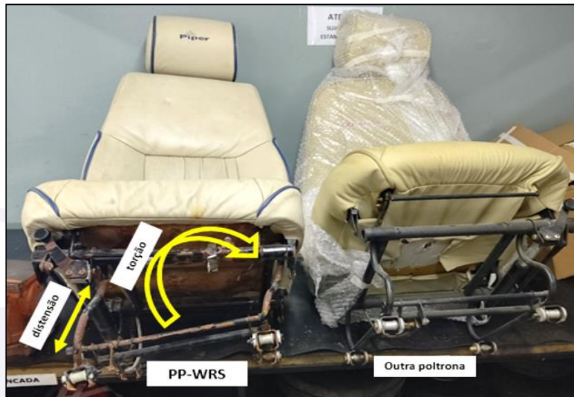
Figura 23 - Estrutura de sustentação do assento do PP-WRS com deformação, comparado à poltrona não acidentada.
