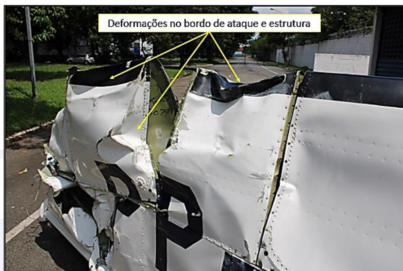
Figura 15 - Deformações do bordo de ataque da asa e estrutura dos tanques de combustível.
