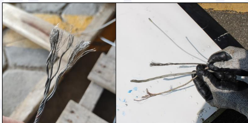
Figura 22 - Cabo de comando do aileron direito rompido.
