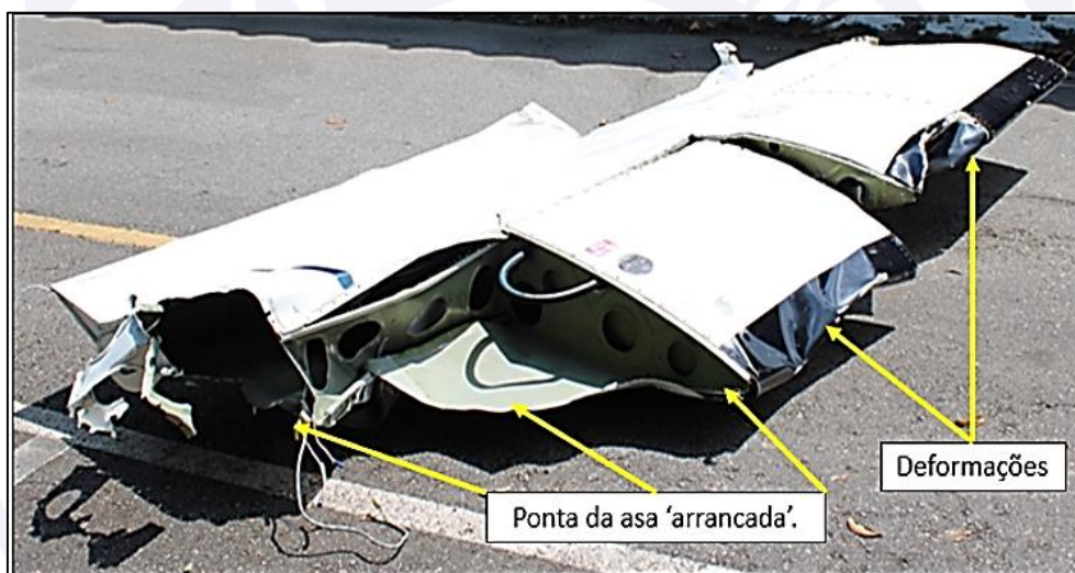
Figura 16 - Deformações no bordo de ataque e ponta da asa.
