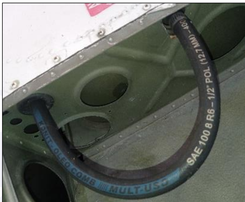
Figura 19 - Visualização da mangueira e braçadeira de uso não aeronáutico.
