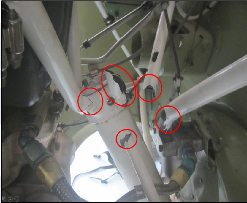
Figura 4 - Hastes de conexão do berço do motor com a bequilha rompidas.
