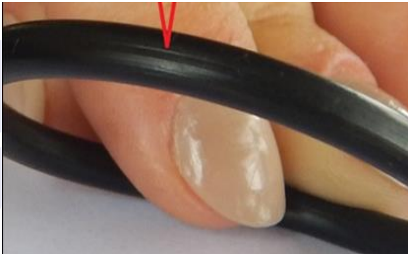
Figura 7 - Gaxeta com destaque para os sinais de desgaste.
