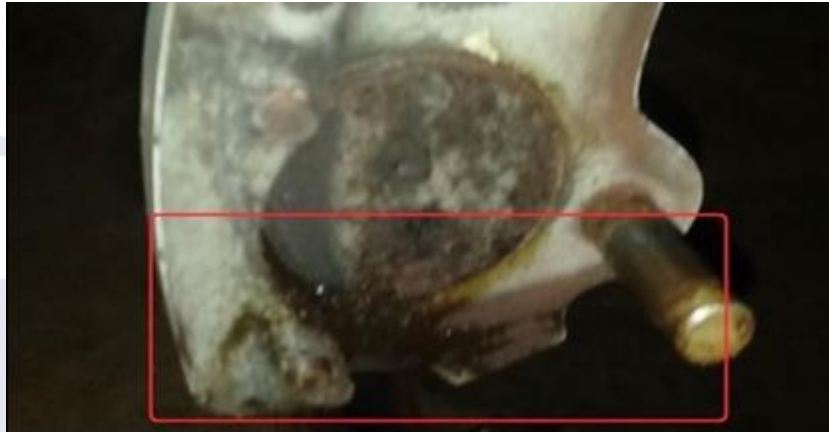
Figura 4 - Pistão inferior, com destaque para o vazamento de óleo.
