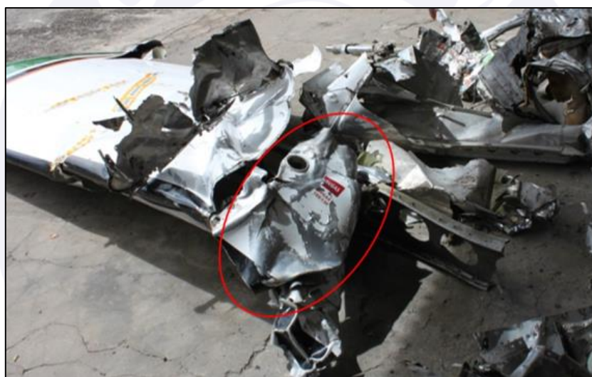
Figura 33 - Reconstituição do tanque direito em relação à asa direita.
