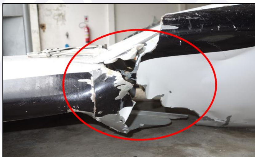
Figura 29 - Marca de impacto no bordo de ataque da asa direita, possivelmente com o estabilizador vertical.
