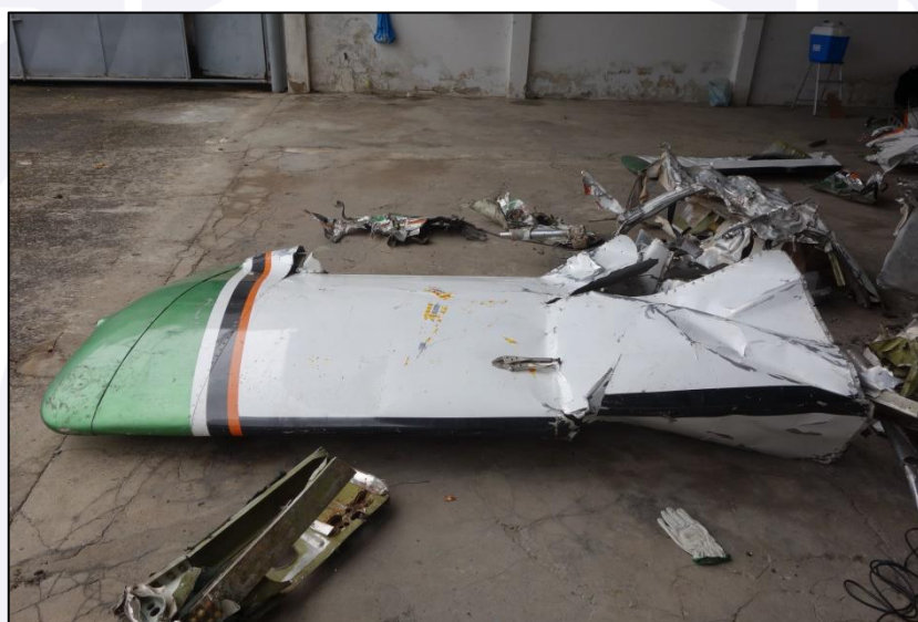
Figura 24 - Painel da asa direita que se desprendeu em voo.
