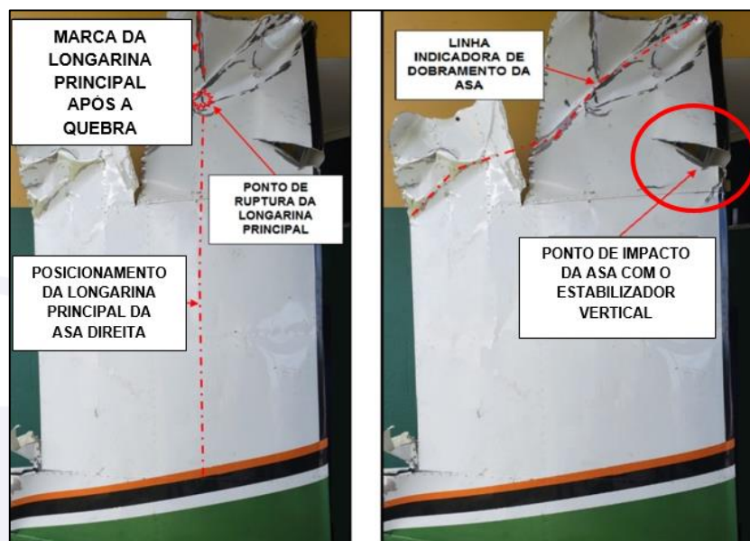
Figura 28 - Aspecto da marca da dobra da asa direita.
