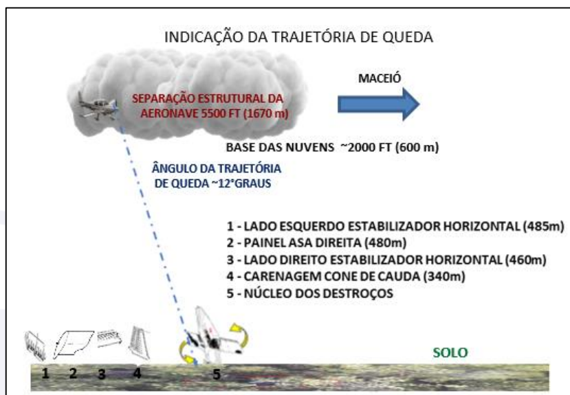
Figura 41 - Ângulo estimado da trajetória de queda do PT-KLO.
