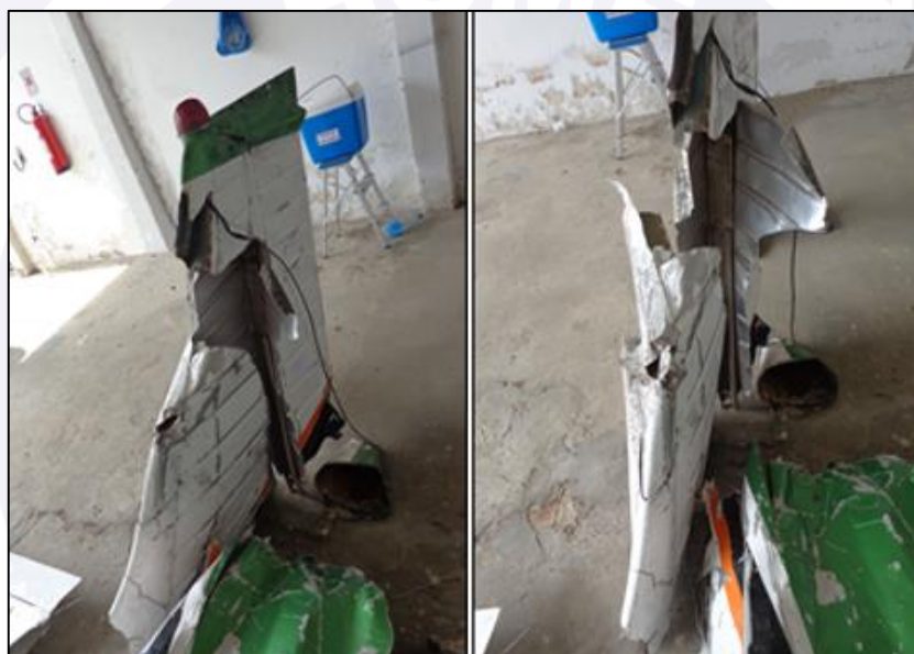
Figura 31 - Aspecto dos danos e deformações no estabilizador vertical.
