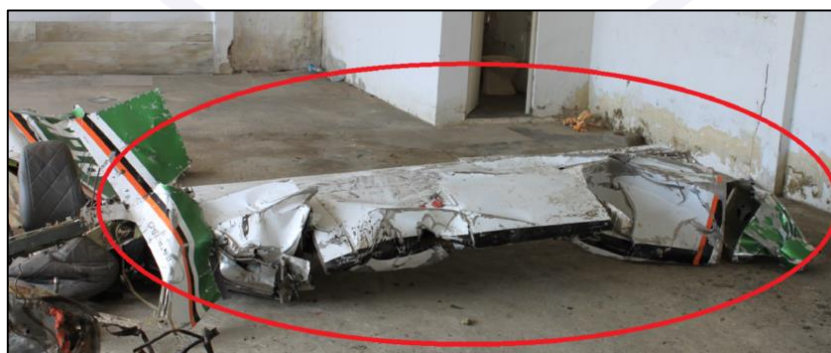
Figura 34 - Asa esquerda e os danos decorrentes dos impactos.
