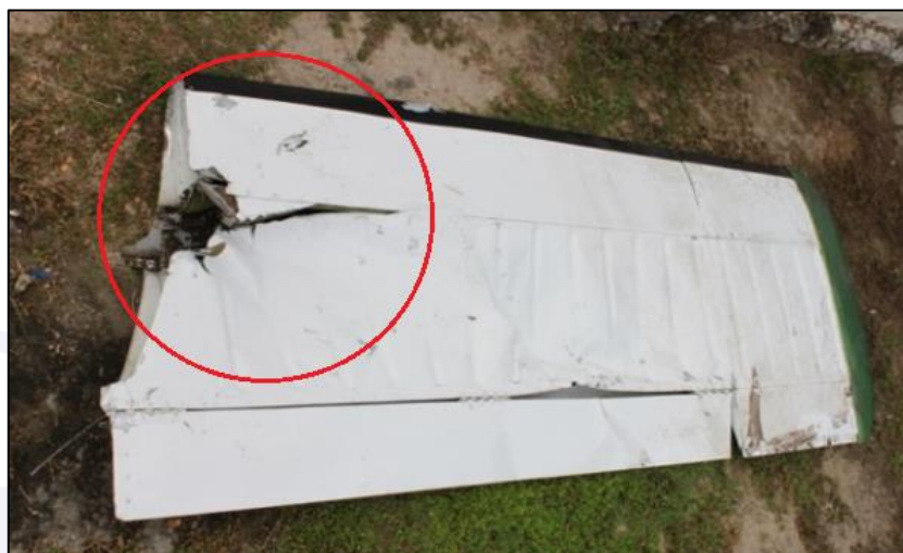
Figura 32 - Parte superior do lado direito do estabilizador horizontal, evidenciando o ponto da quebra da sua longarina, por sobrecarga.
