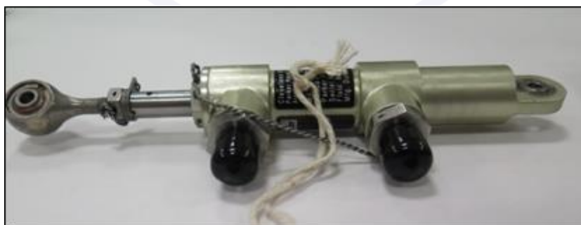
Figura 2 - Vista de um dos quatro cilindros mestres instalados na aeronave.
