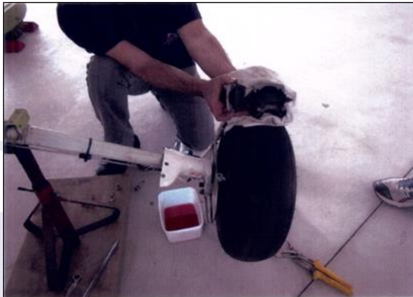
Figura 2 - Desmontagem dos sistemas de freios da aeronave.
