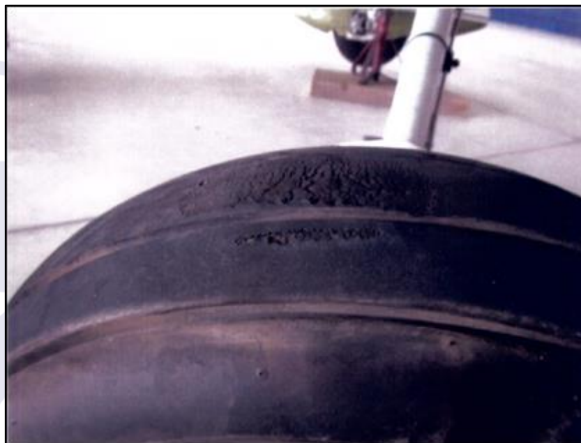
Figura 7 - Aspecto característico de derrapagem.
