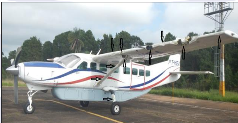
Figura 3 - Danos na asa esquerda, no trem de pouso principal esquerdo e no montante da asa.
