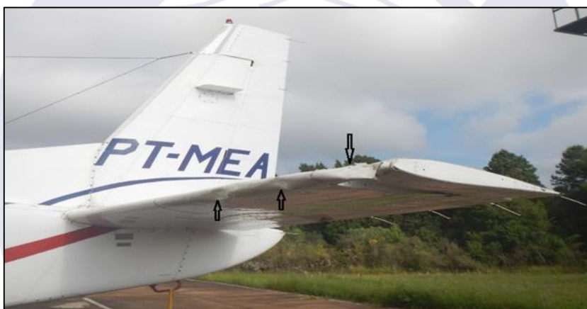
Figura 4 - Avarias no estabilizador horizontal esquerdo.
