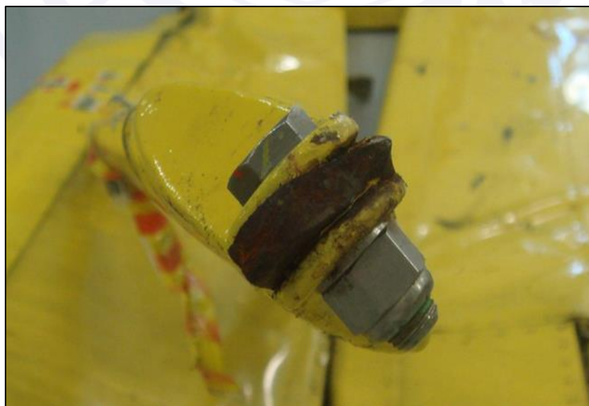
Figura 10 - Superfície de fratura com característica de sobrecarga (Detalhe da Figura 8).
