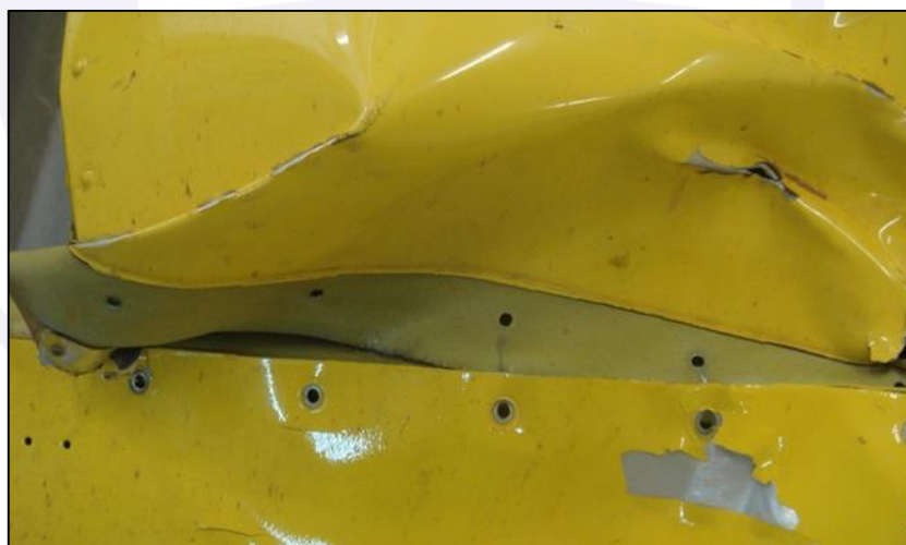
Figura 4 - Perda de rebites na superfície do estabilizador horizontal esquerdo.
