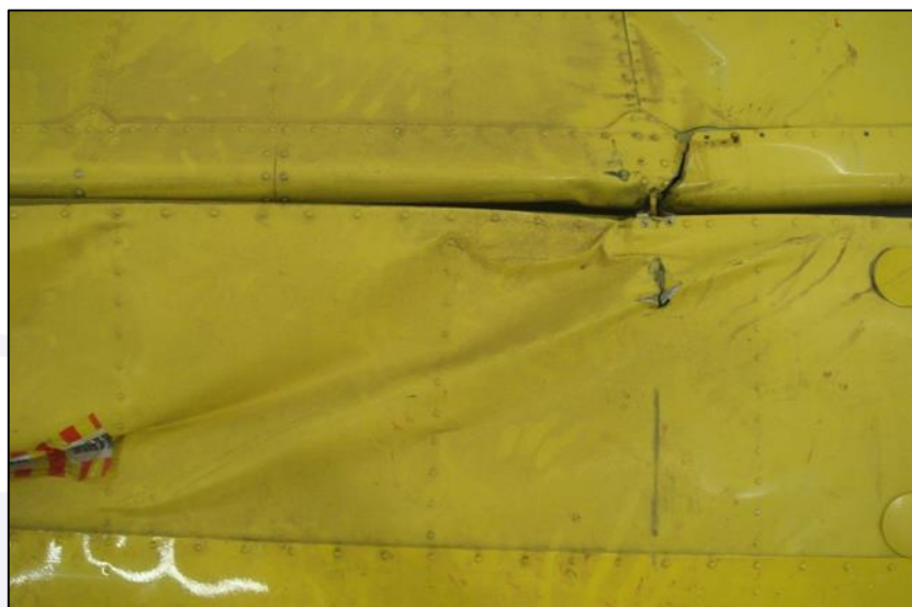
Figura 5 - Deformação plástica na superfície do estabilizador horizontal esquerdo.
