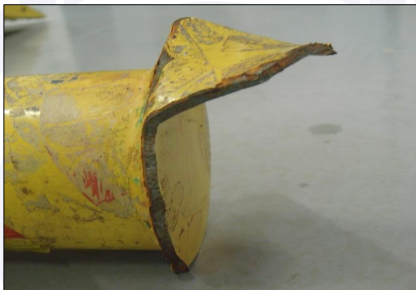
Figura 9 - Superfície com características típicas de fratura por sobrecarga na estrutura (Detalhe da Figura 8).
