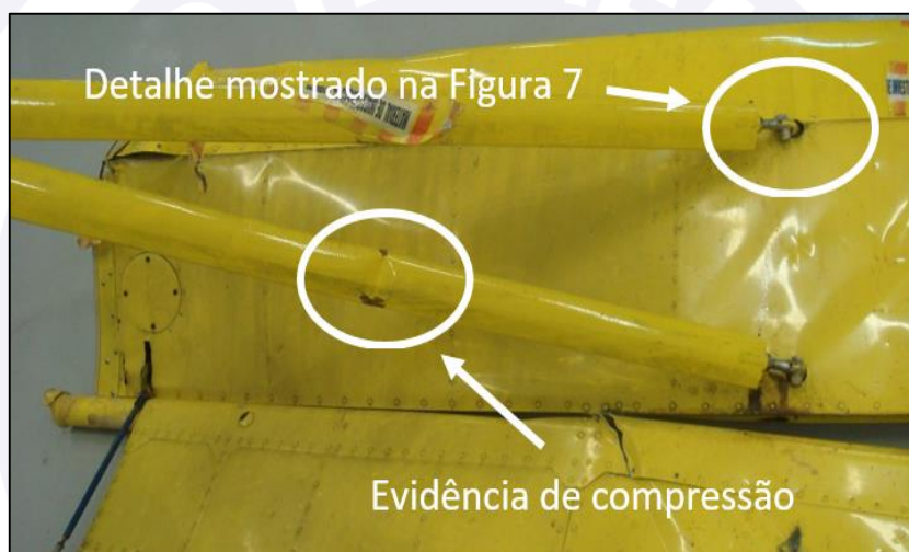
Figura 6 - Visão geral do montante e deformação por compressão.
