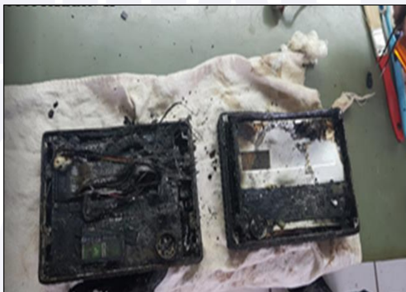
Figura 12 - Condições físicas do DGPS que equipava a aeronave PR-AJF quando de sua abertura em laboratório especializado.
