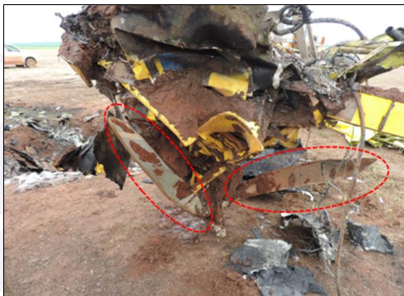
Figura 3 - Grau de destruição do grupo motopropulsor e, em destaque, apenas duas das três pás do conjunto de hélice.
