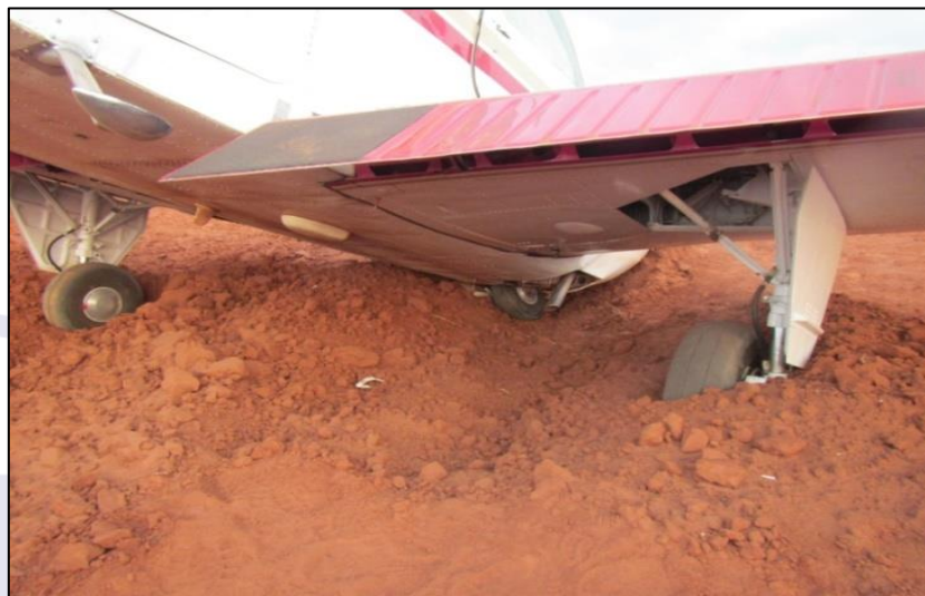
Figura 8 - Vista dos danos no trem de pouso (posição “embaixo”).
