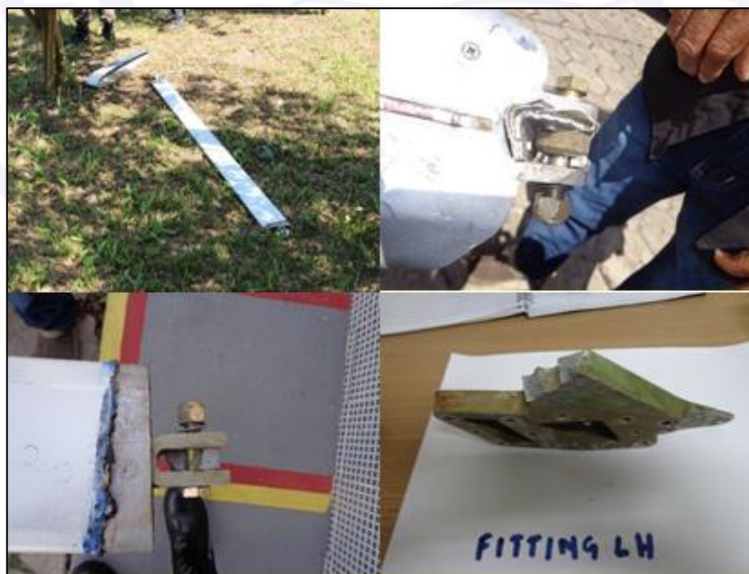
Figura 6 - Montante da asa esquerda com pontos de fixação fraturados.
