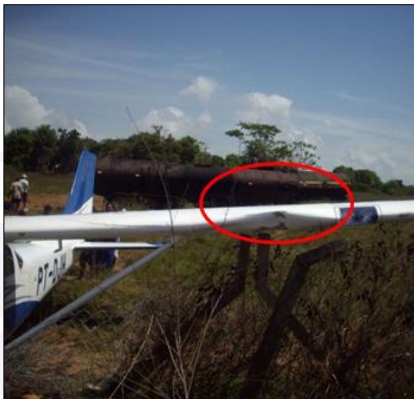
Figura 14 - Danos no bordo de ataque da asa esquerda (22DEZ2012).
