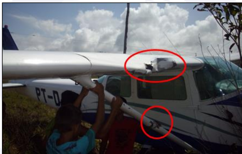
Figura 15 - Danos no bordo de ataque da asa direita e no montante da asa (22DEZ2012).
