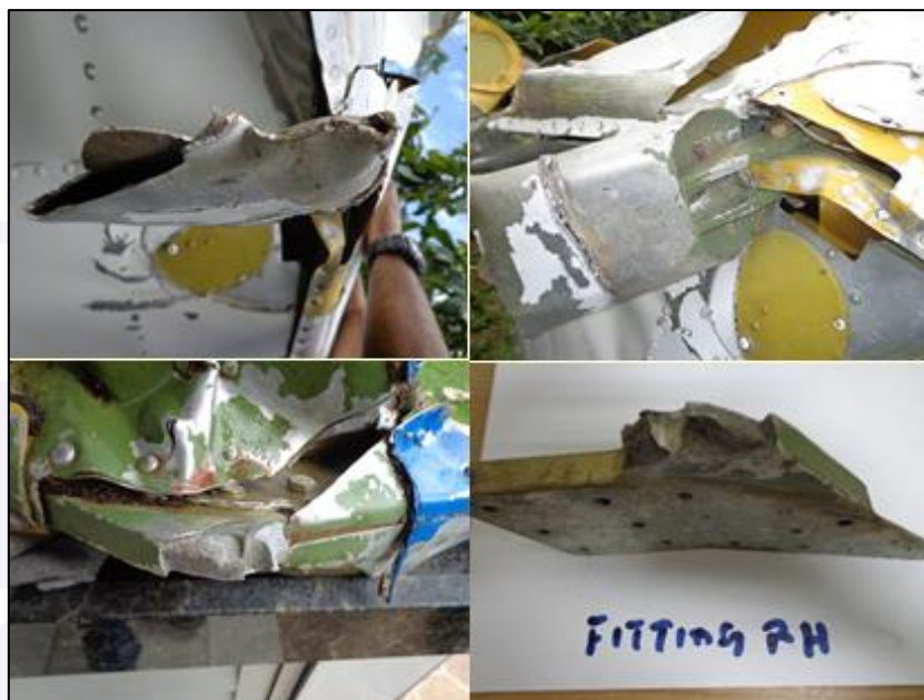
Figura 7 - Pontos de fixação do montante da asa direita fraturados.
