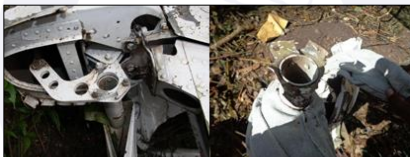
Figura 8 - Profundor esquerdo fraturado.
