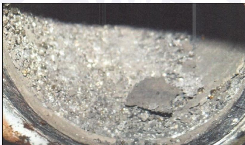
Figura 9 - Vitrificação do depósito de chumbo observada no escape do cilindro 3.
