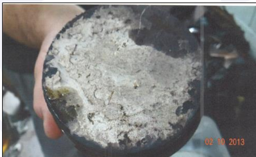
Figura 7 - Cabeça do pistão do cilindro 1 com evidência de operação com temperatura elevada e mistura pobre.
