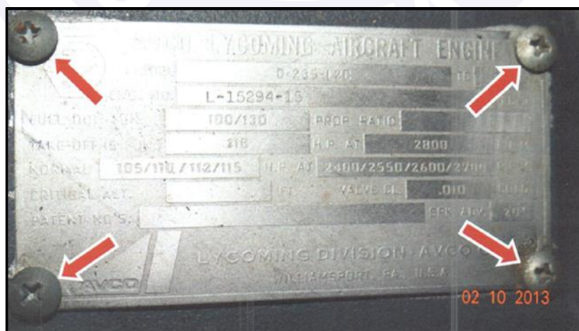
Figura 2 - Plaqueta de identificação do motor fixada com parafusos de fácil remoção.
