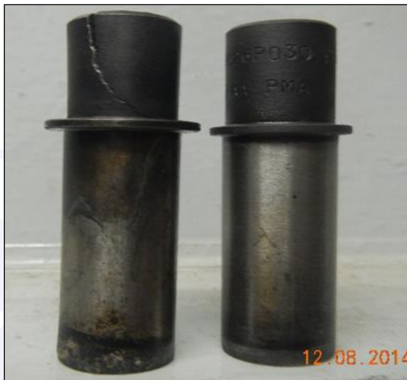
Figura 13 - Comparação entre a guia da válvula do cilindro 3 (lado esquerdo) rachada e sem identificação de PN e uma original (lado direito).
