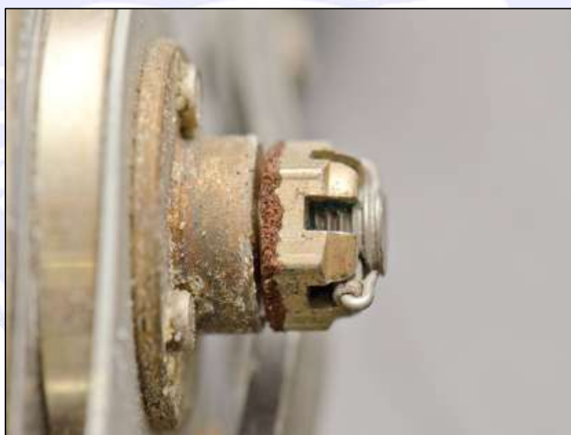
Figura 25 – Separação entre o parafuso e a porca do batente do mecanismo de ajuste de fricção.
