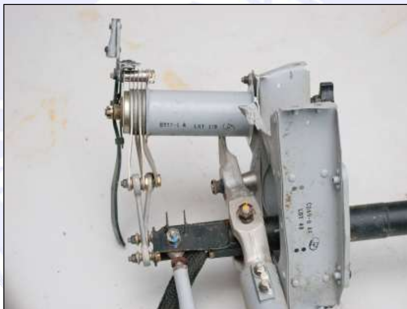
Figura 23 – Amassamentos e deformações nas partes móveis do comando cíclico.
