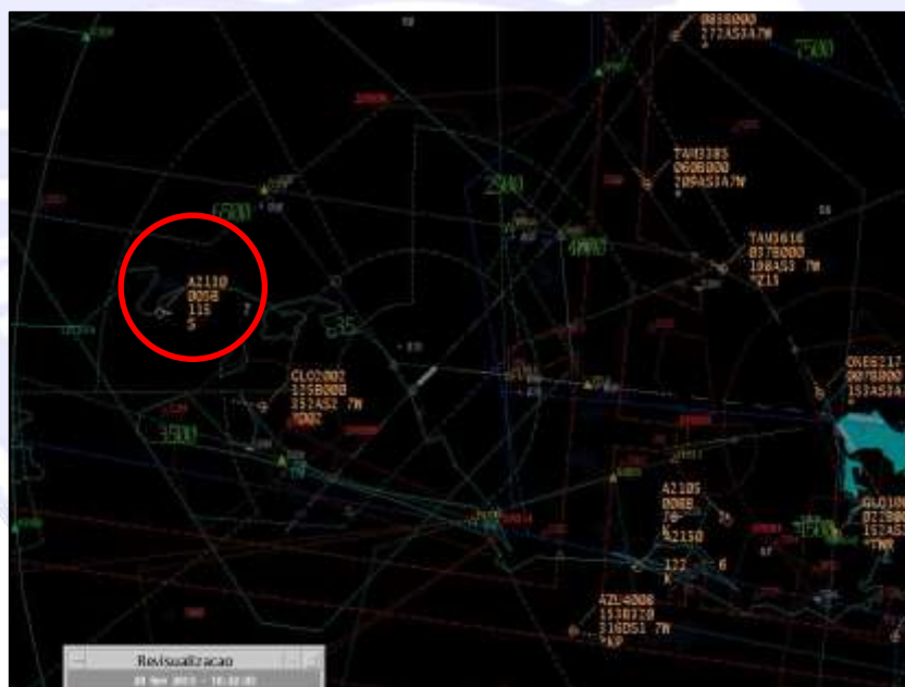
Figura 1 – Síntese radar instantânea antes da ocorrência com o PR-MXM. Em destaque (círculo vermelho) a posição da aeronave acidentada abordando a face sul da elevação da Praia do Junqueira.
