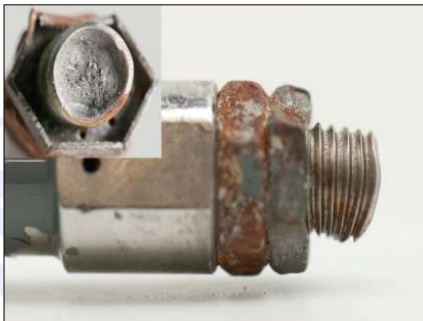
Figura 22 – Amassamento e deformação com inclinação de 45°.
