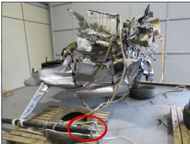
Figura 12 – Esqui esquerdo com quebra na parte traseira.
