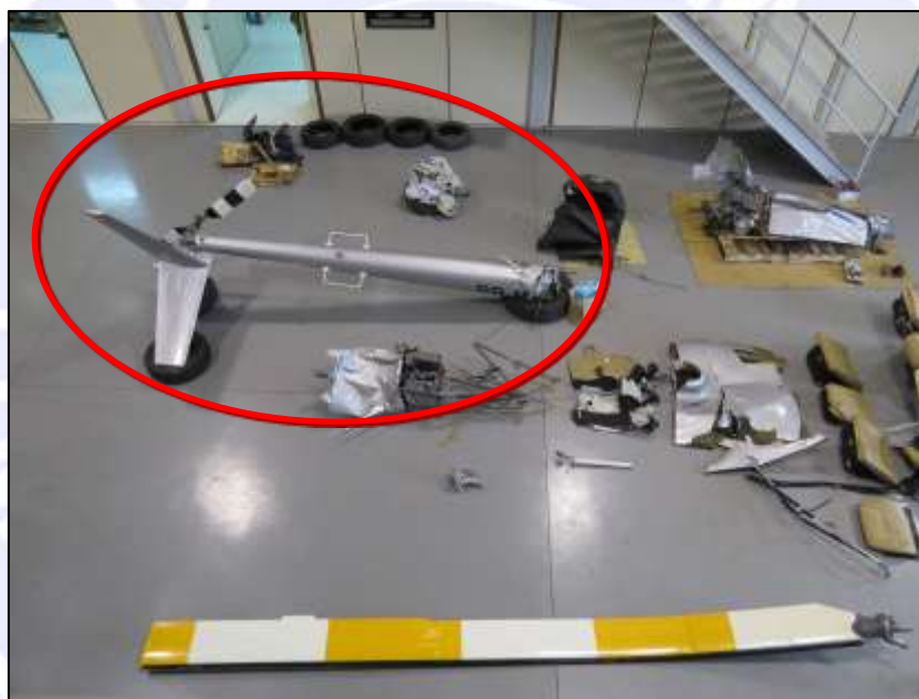
Figura 8 – Reconstituição da aeronave no hangar do SERIPA III, com destaque para o cone ( boom ) de cauda.
