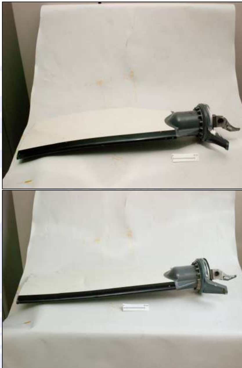
Figura 18 – Spindles das pás seccionadas encaminhados ao DCTA para análise.
