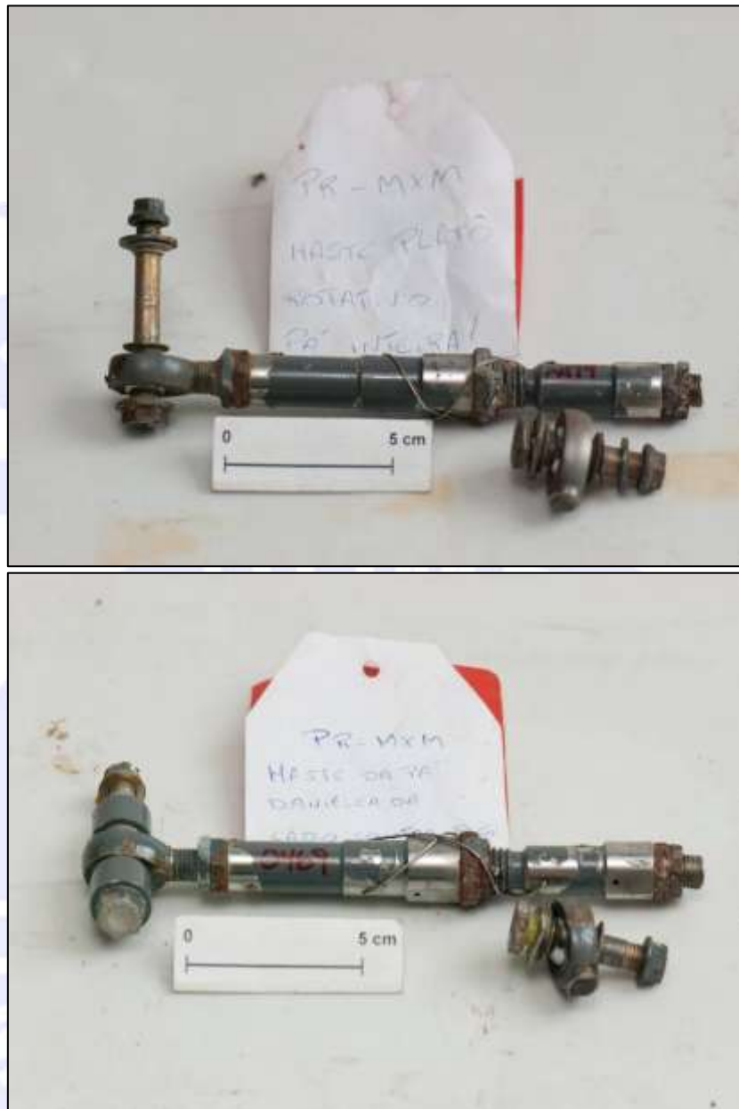
Figura 17 – Pitch links da aeronave encaminhados ao DCTA para análise.
