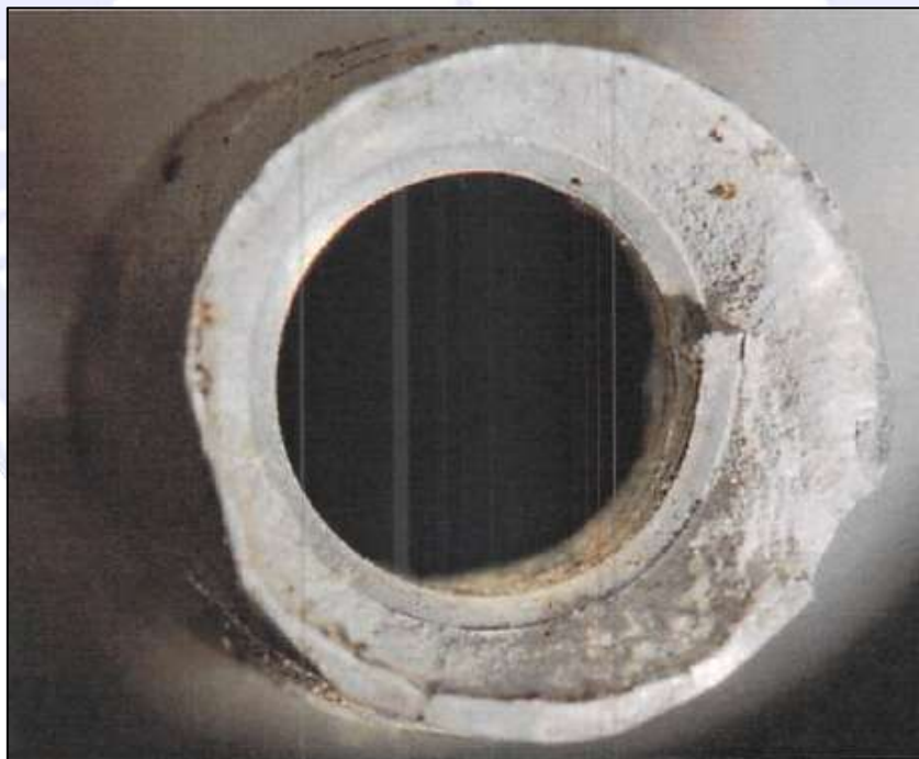
Figura 27 – Haste de comando de voo fraturado por sobrecarga, com inclinação de 45° na superfície da fratura.
