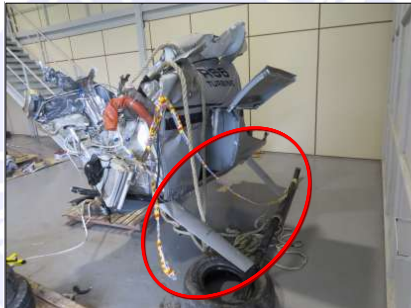
Figura 15 – Strut fairing do esqui direito e parte da fuselagem com poucas avarias.
