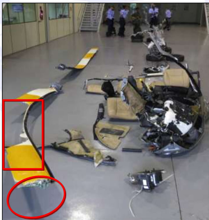
Figura 11 – Bordo de ataque da pá com curvatura para a esquerda do sentido de rotação, ausência de material do perfil da pá e quebra perpendicular à sua extensão.
