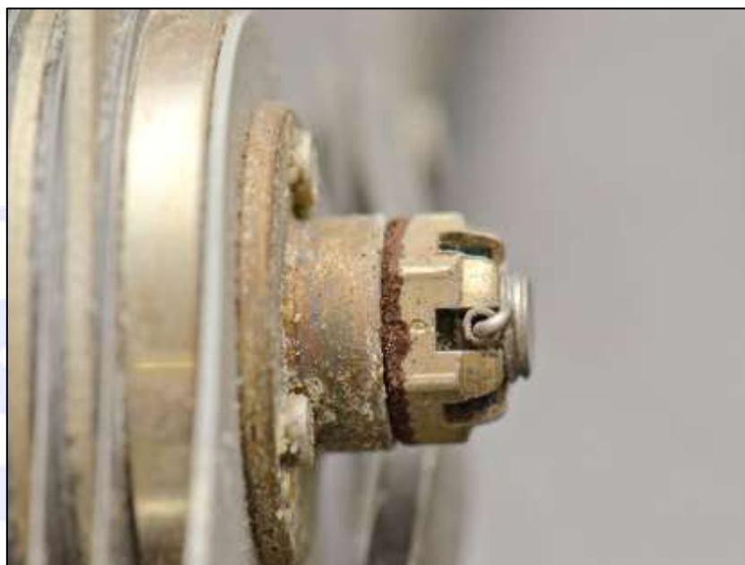
Figura 24 – Parafuso do ajuste de fricção do cíclico no batente anti-horário: sem fricção aplicada.
