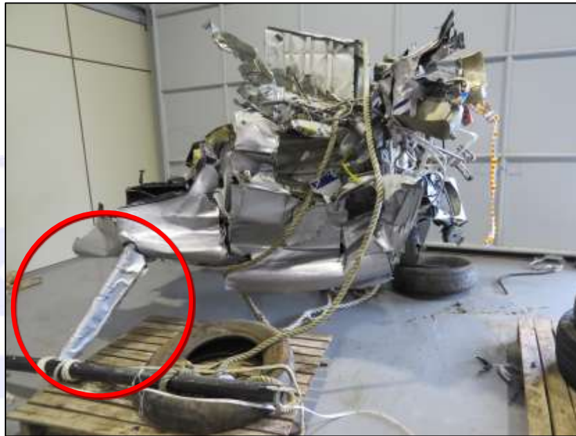
Figura 14 – Forward strut fairing com deformações.
