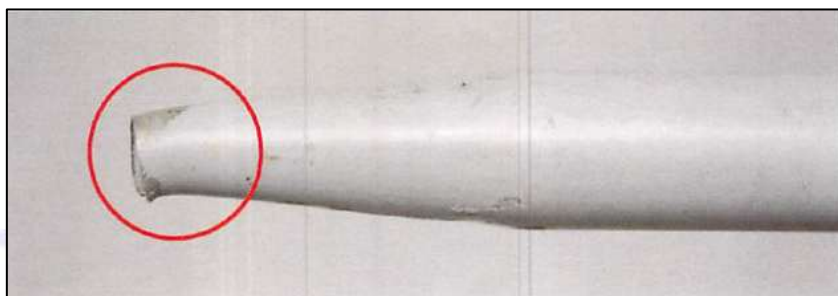
Figura 28 – Haste de comando de voo fraturado por sobrecarga, com deformações plásticas.
