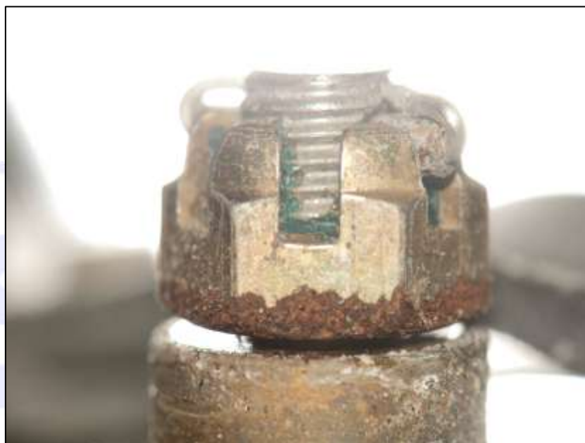
Figura 26 – Inexistência de corrosão no interior do batente do sistema “porca-parafuso”.
