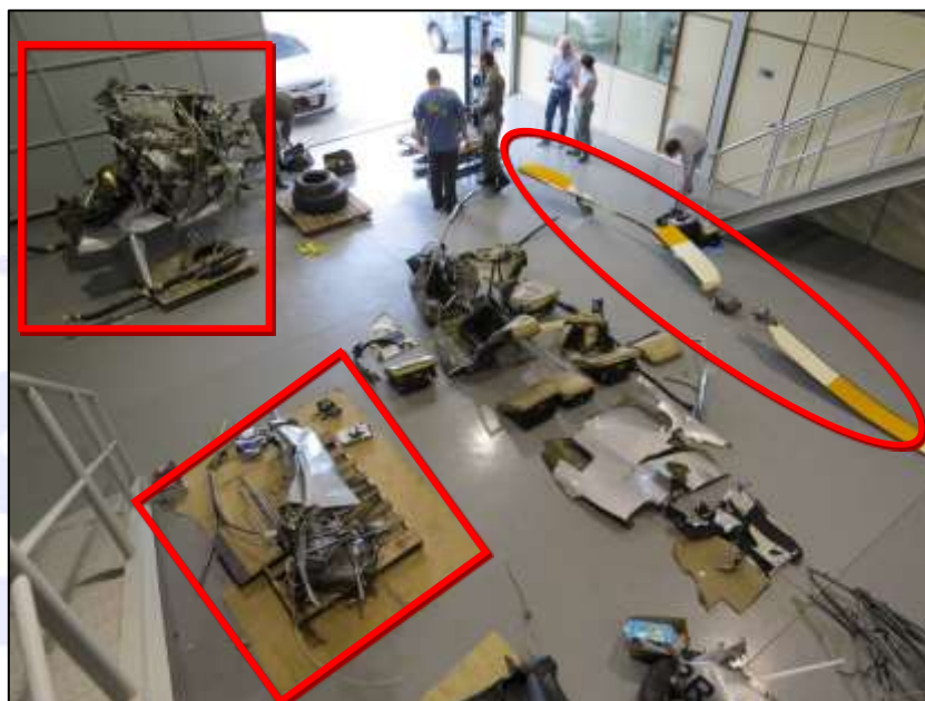
Figura 7 – Reconstituição da aeronave em 2D no hangar do SERIPA III, com destaque para a caixa de transmissão principal, parte da cabine e rotor principal.
