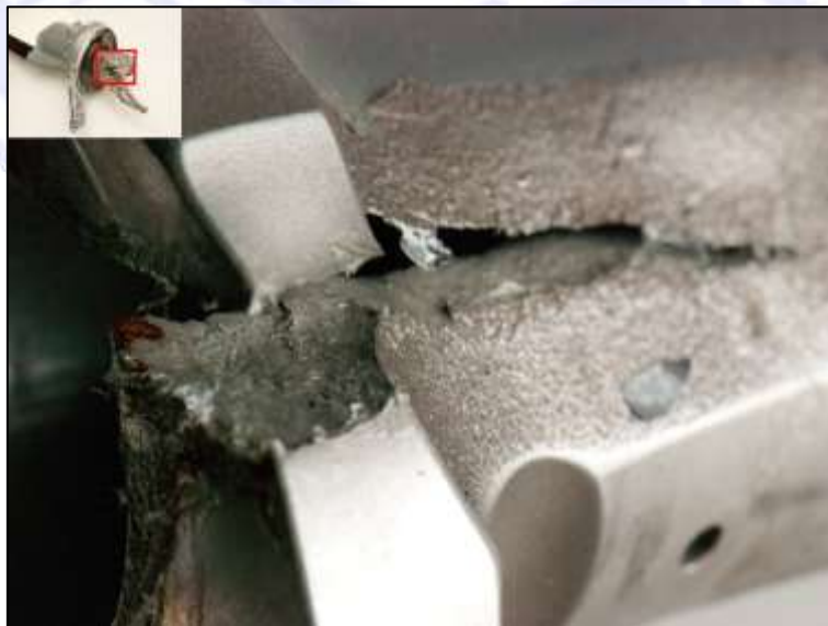
Figura 21 – Superfície de fratura do spindle da pá.
