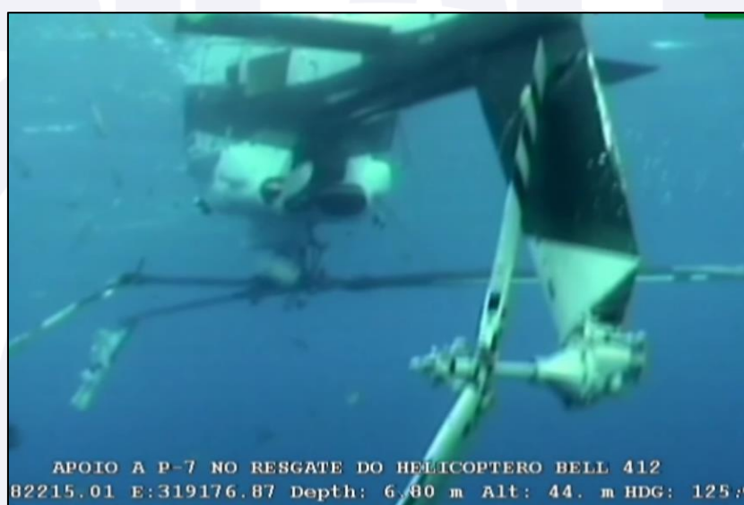
Figura 3 - Tail Boom e Tail Rotor conectados à aeronave.
