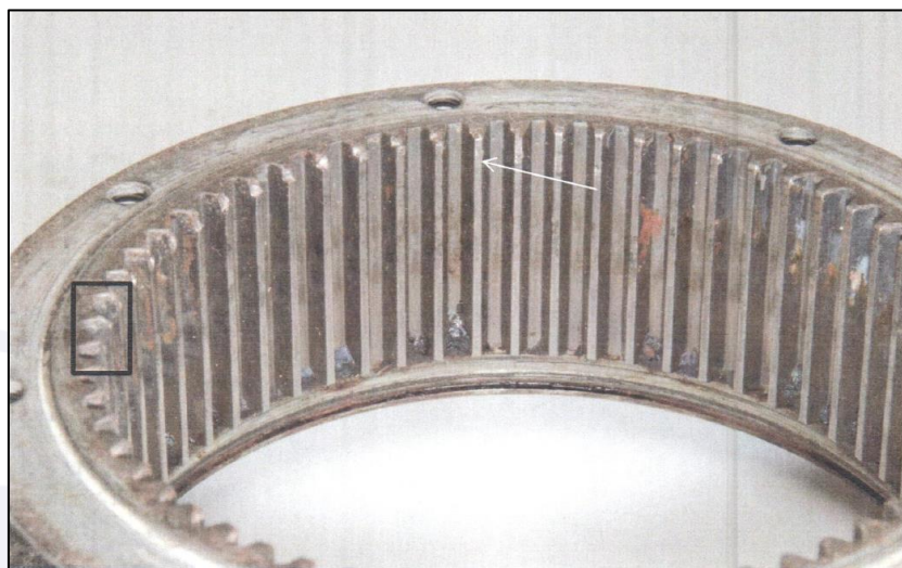
Figura 8 - Aspecto geral da engrenagem. A seta branca indica a sequência de marcas observadas nos dentes da engrenagem.
