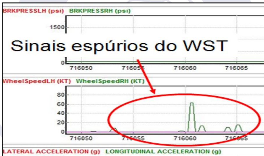
Figura 4 - Vista aproximada da indicação de velocidade nas rodas do trem de pouso com a aeronave em voo.
