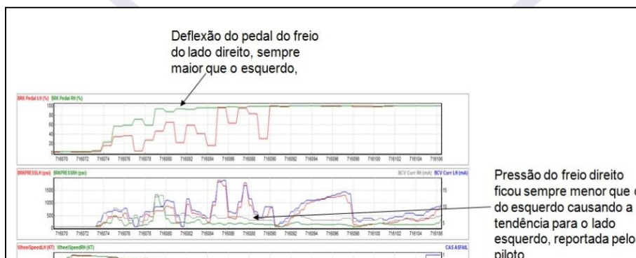
Figura 5 - Deflexão dos pedais do freio versus pressão efetiva.
