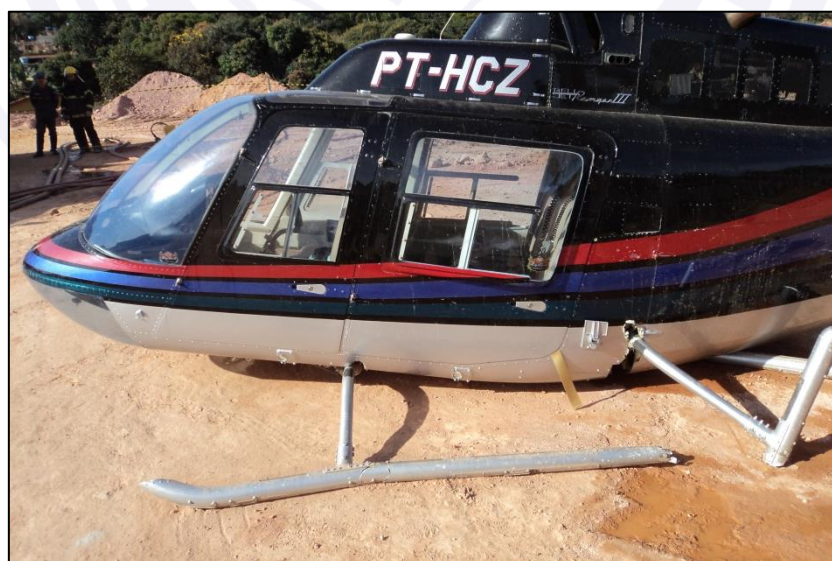
Figura 1 - Danos à aeronave após o pouso brusco.
