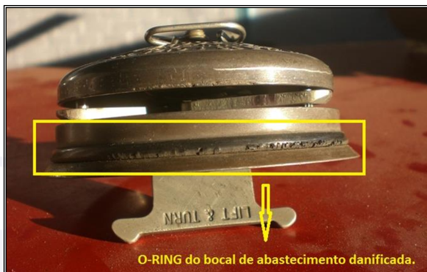
Figura 5 - Tampa do bocal de abastecimento da aeronave. Em destaque a deterioração do o-ring de vedação.
