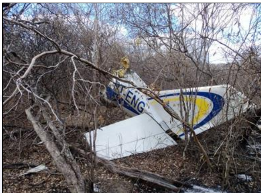
Figura 2 - Empenagem traseira separada, após o impacto contra as árvores.
