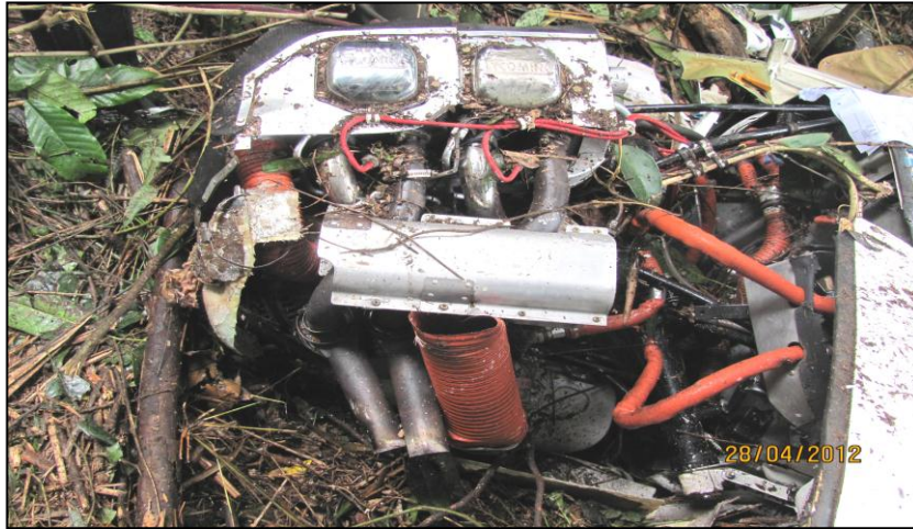
Figura 7 - Motor no local da ocorrência.
