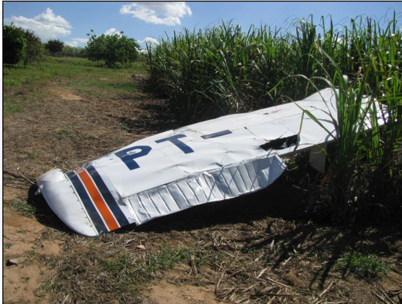
Figura 2 - Asa esquerda da aeronave PT-NKA e seus vários amassamentos.
