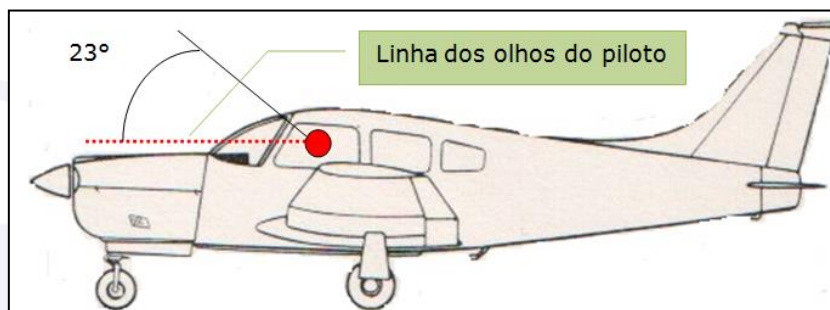
Figura 6 - Perfil lateral da aeronave e campo visual do observador (piloto) estático no assento esquerdo.
