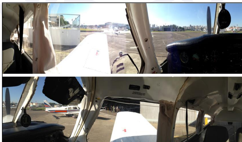
Figura 5 - Campo visual dos pilotos e os “pontos cegos” proporcionados pelas asas e pelas colunas entre as janelas.
