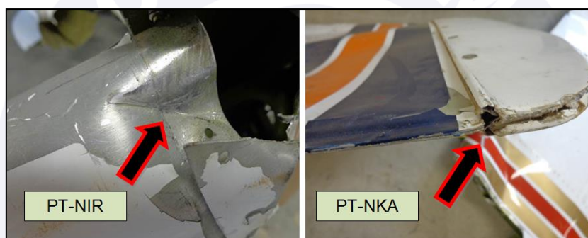
Figura 4 - Regiões de provável contato entre as asas.
