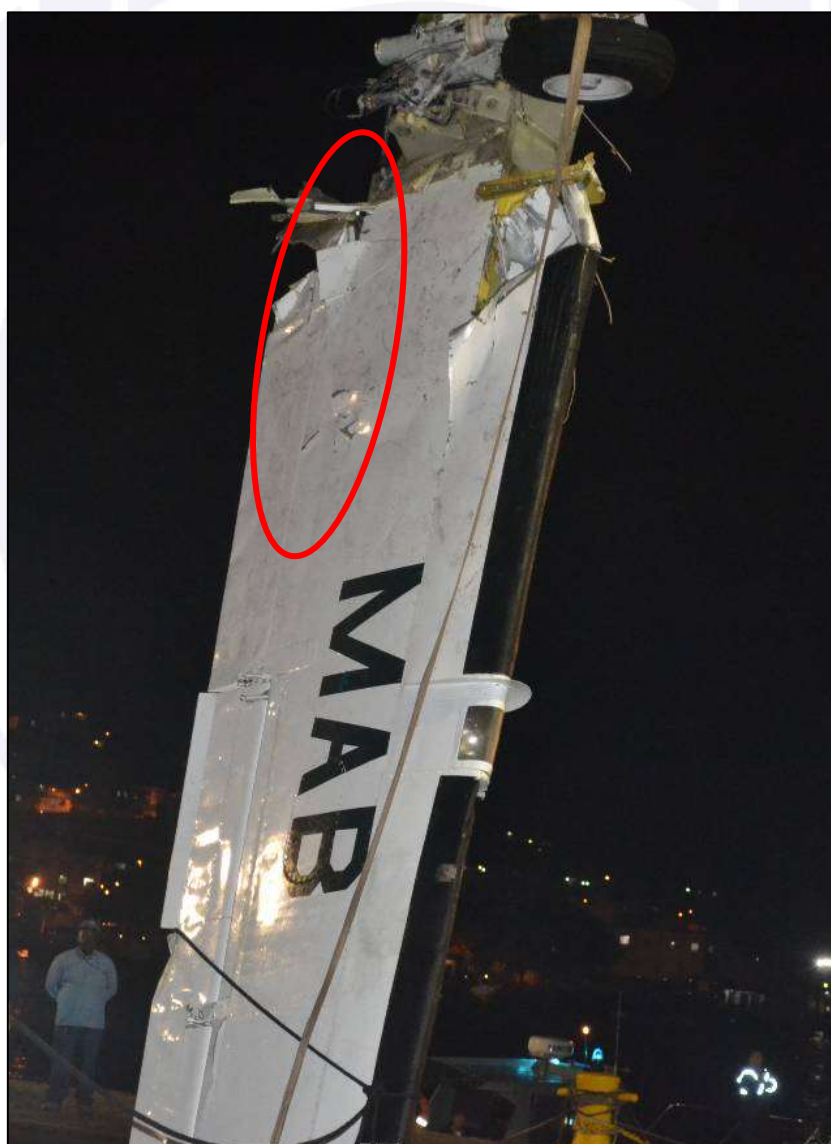
Figura 9 - Asa esquerda sendo içada para transporte. Em detalhe, flap recolhido.
