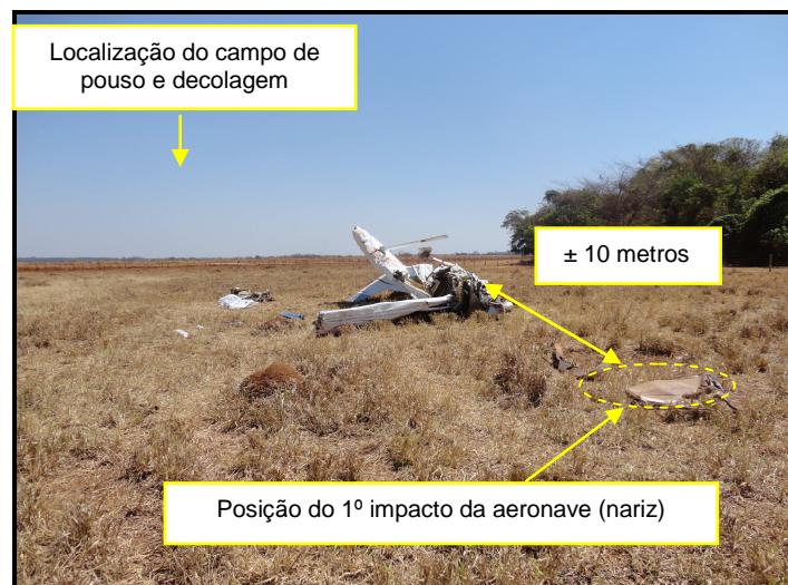
Figura 3 - Posicionamento da aeronave após o acidente.
