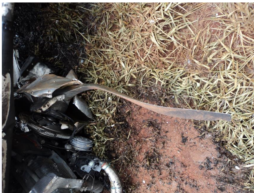
Figura 5 – Deformação em uma das pás do motor da aeronave com evidências de impacto de grande ângulo e contra solo macio.
