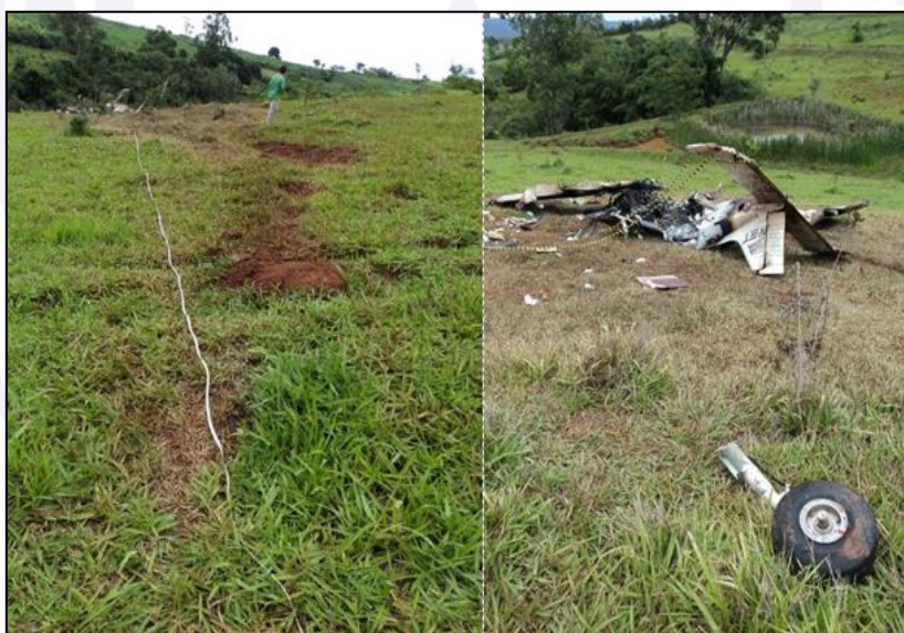
Figura 4 - Trajetória da aeronave após a colisão contra o solo, perna do trem de pouso que se desprendeu da aeronave após o impacto (primeiro plano) e concentração dos destroços (ao fundo).
