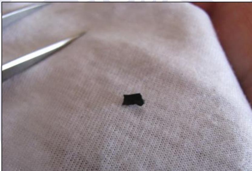
Figura 2 - Material expelido pela unidade controladora de combustível do PP-CIE.
