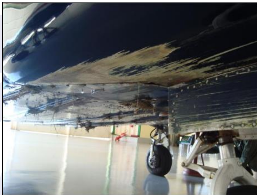
Figura 1 - Danos na parte inferior da aeronave após pouso sem trem.
