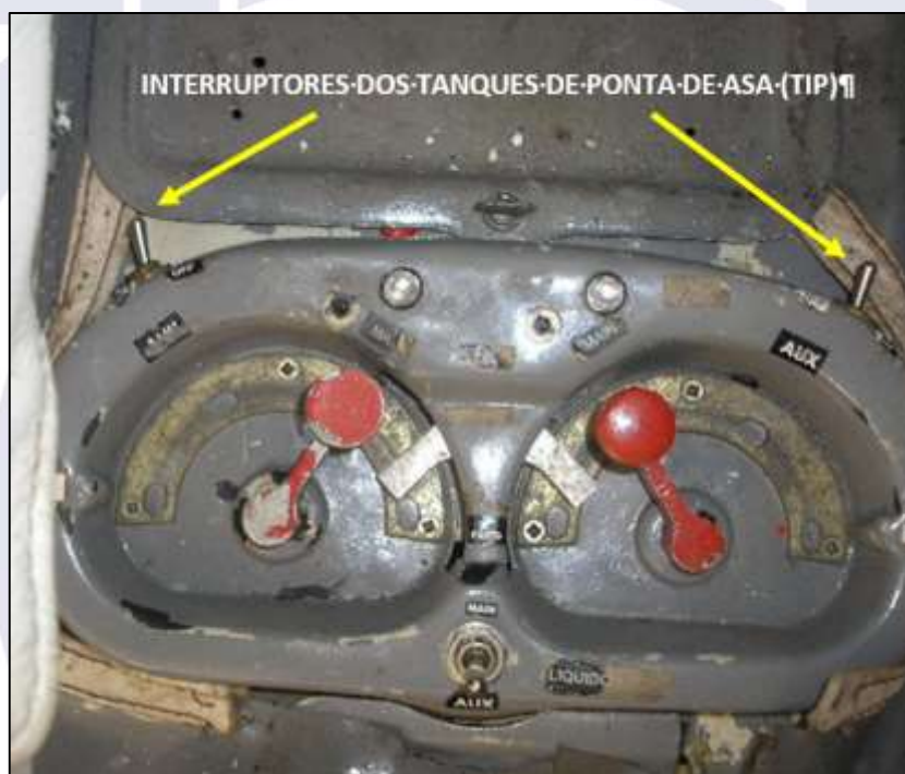
Figura 3 - Controles do sistema de combustível.
