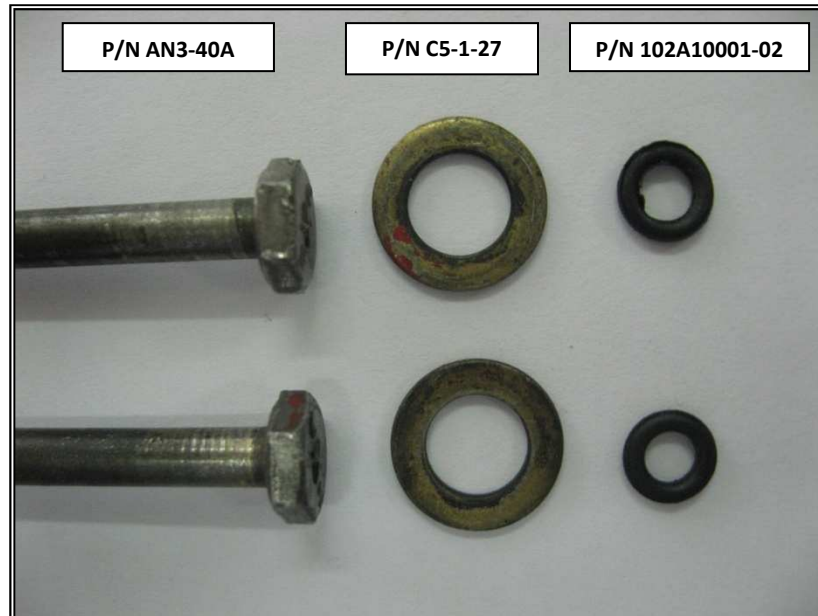
Foto 02 - Conjunto de montagem da bomba.
