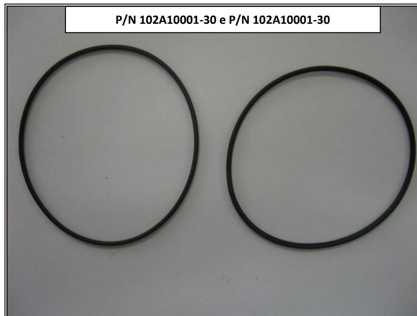
Foto 03 - Anéis de vedação do corpo da bomba.
