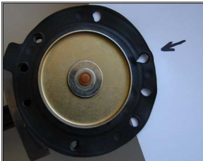
Foto 04 – Diafragma da bomba principal
