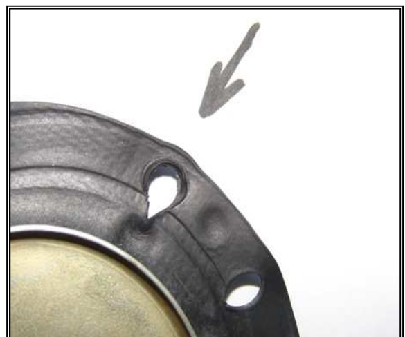
Foto 05 – Orifício fora do perfil e das dimensões previstas
