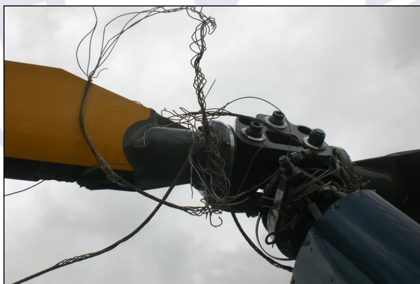
Figura 2 - Colisão contra os fios da rede de energia elétrica.
