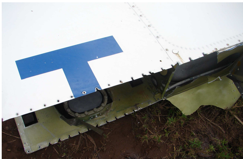
Figura Nº3 Detalhe dos parafusos arrancados por sobrecarga
