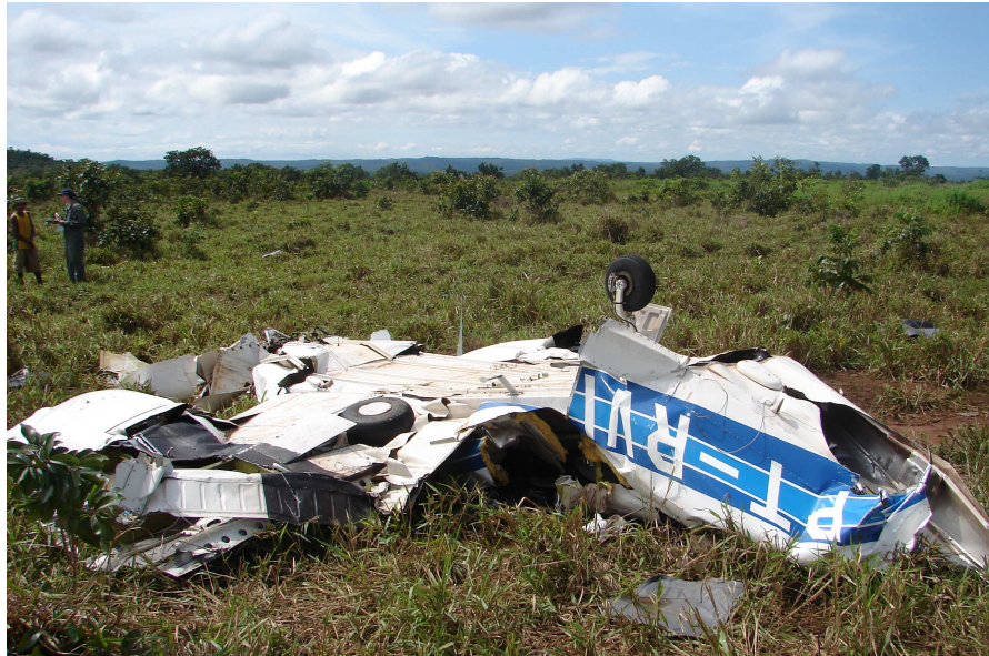
Figura N°1 Parte principal dos destroços “fuselagem”.
