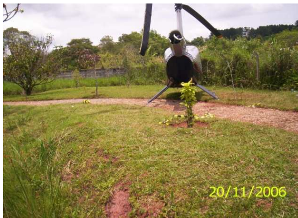
Fotos 1 e 2: Características do impacto e do cone de cauda seccionado.
