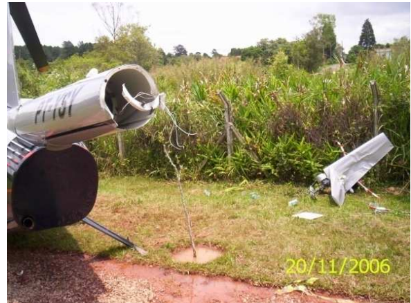
Fotos 1 e 2: Características do impacto e do cone de cauda seccionado.
