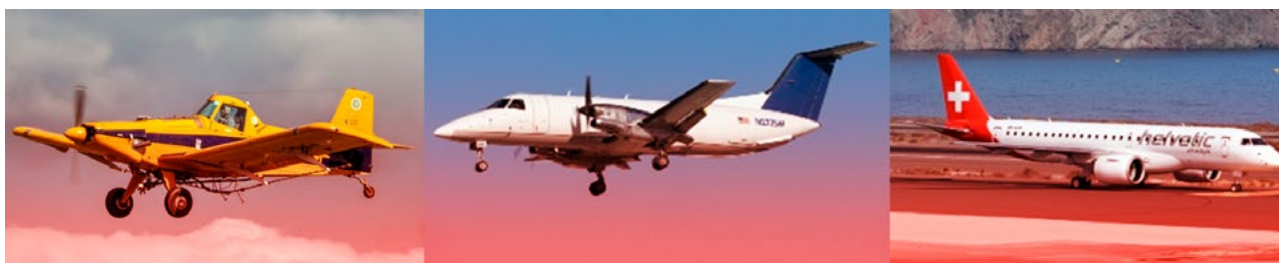
Figura 12: exemplos de aeronaves – da esquerda para a direita: aeronave a pistão, aeronave turboélice e aeronave a jato.
