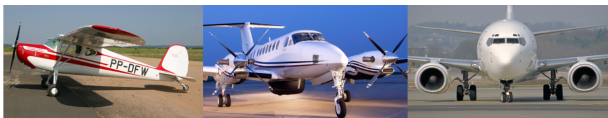
Figura 12: exemplos de aeronaves – da esquerda para a direita: aeronave a pistão, aeronave turboélice e aeronave a jato.
