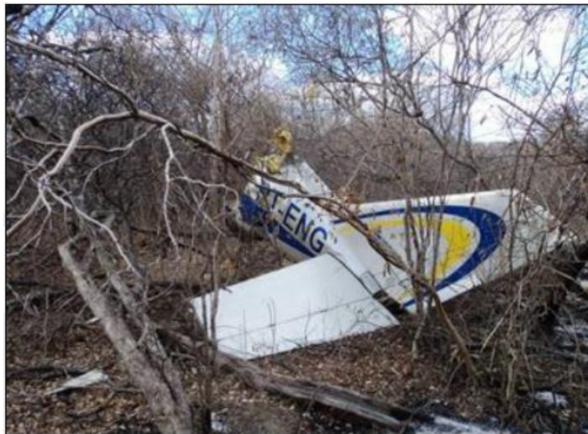
Empenagem traseira separada, após o impacto contra as árvores
