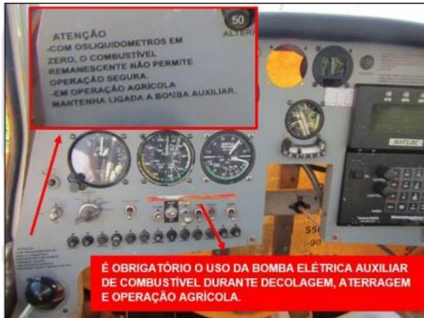
**Painel da aeronave com os avisos sobre a necessidade de manter ligada a bomba auxiliar**
