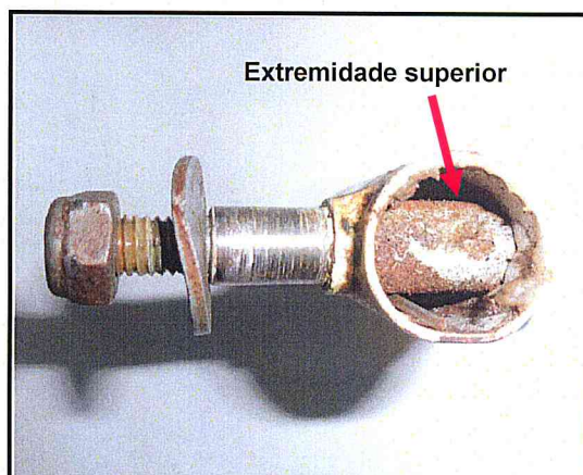
Foto 05 – vista da extremidade superior da alavanca (sem proteção).
