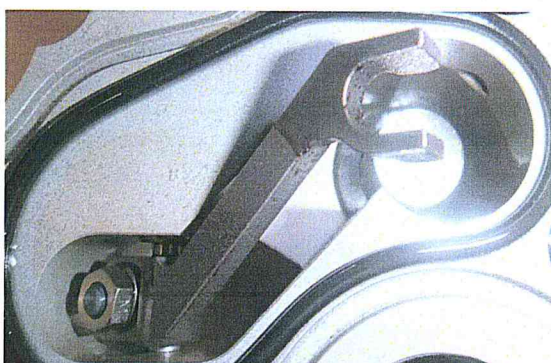
Foto 9 – haste de acionamento da metering valve da FCU
