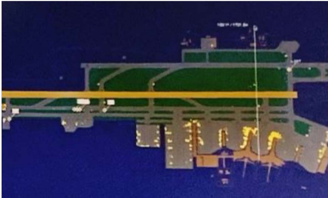
Foto do display do radar de movimento de superfície disponível no Aeroporto Internacional de Guarulhos.
