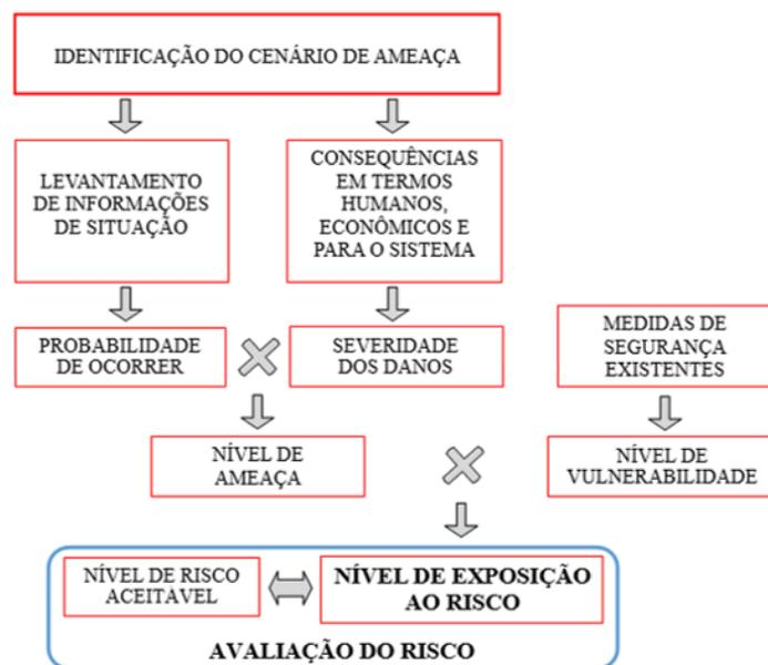
Figura 6 – Fluxograma de avaliação de riscos (Manual de Avaliação de risco AVSEC para Operador de Aeródromo e Operador Aéreo, 2021)
