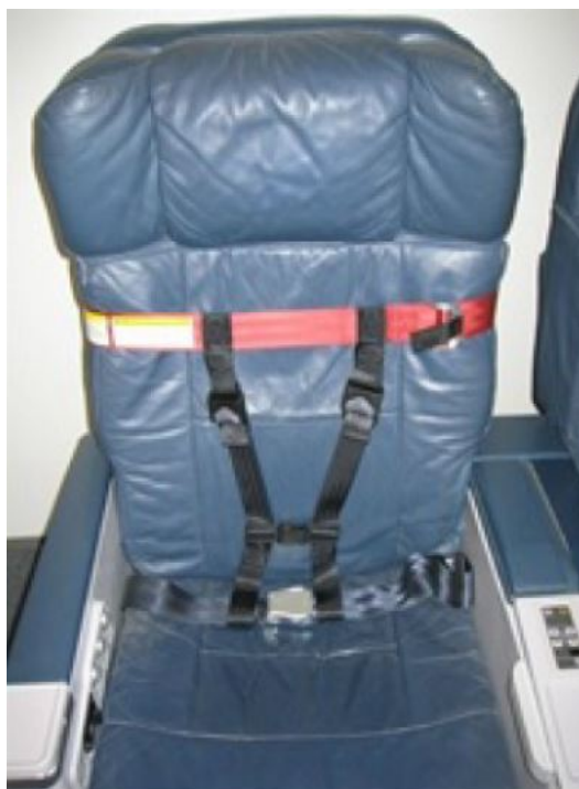
Figura 02 - Cinto de torso (Fonte: FAA AC 120-87 revisão C)
