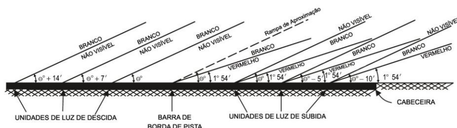
Figura D-14. Feixes de luzes e configurações de elevação do T-VASIS e AT-VASIS
