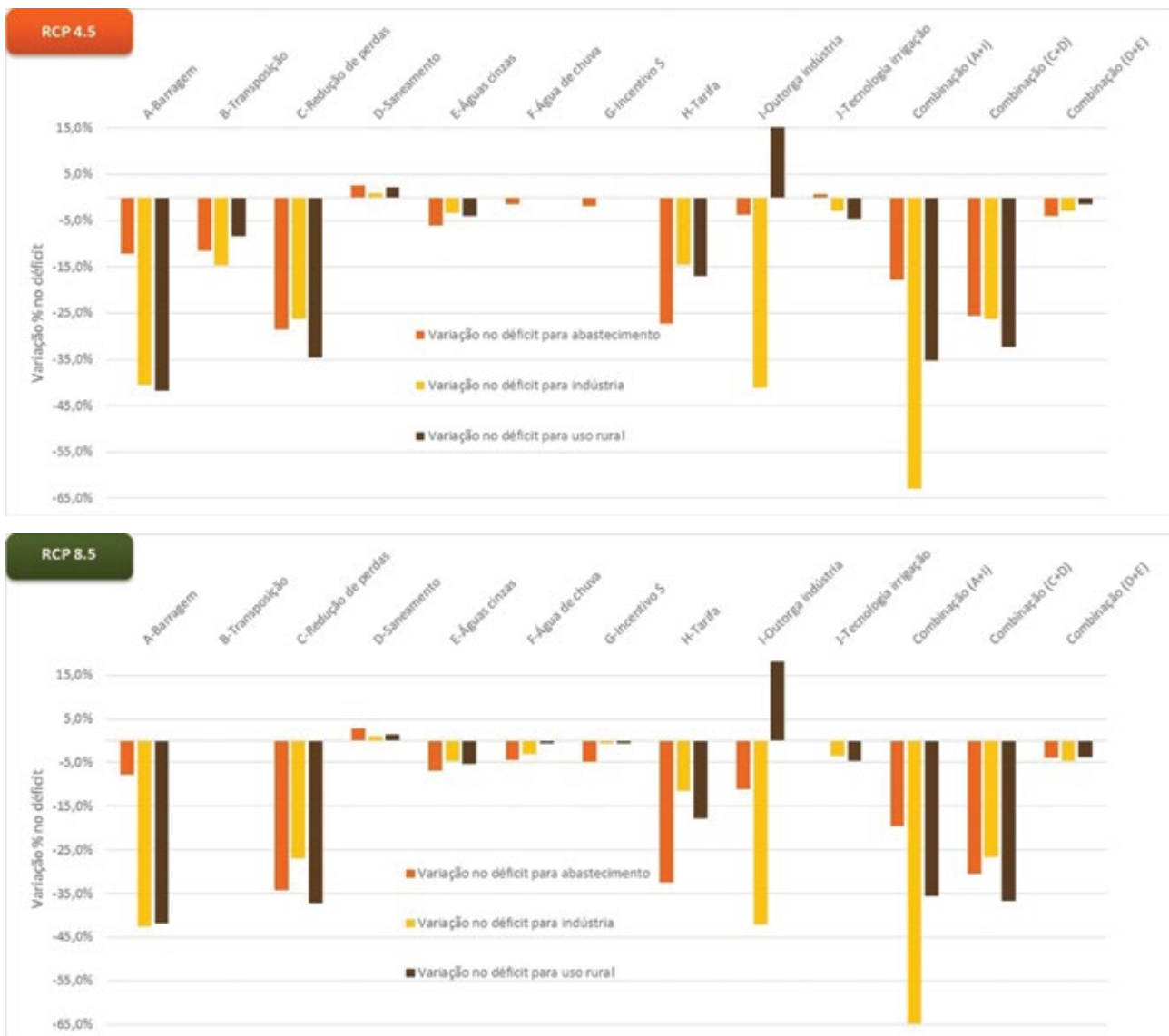
Figura 8: Variação percentual no déficit hídrico com aplicação das medidas adaptativas para os cenários RCP 4.5 e RCP 8.5
