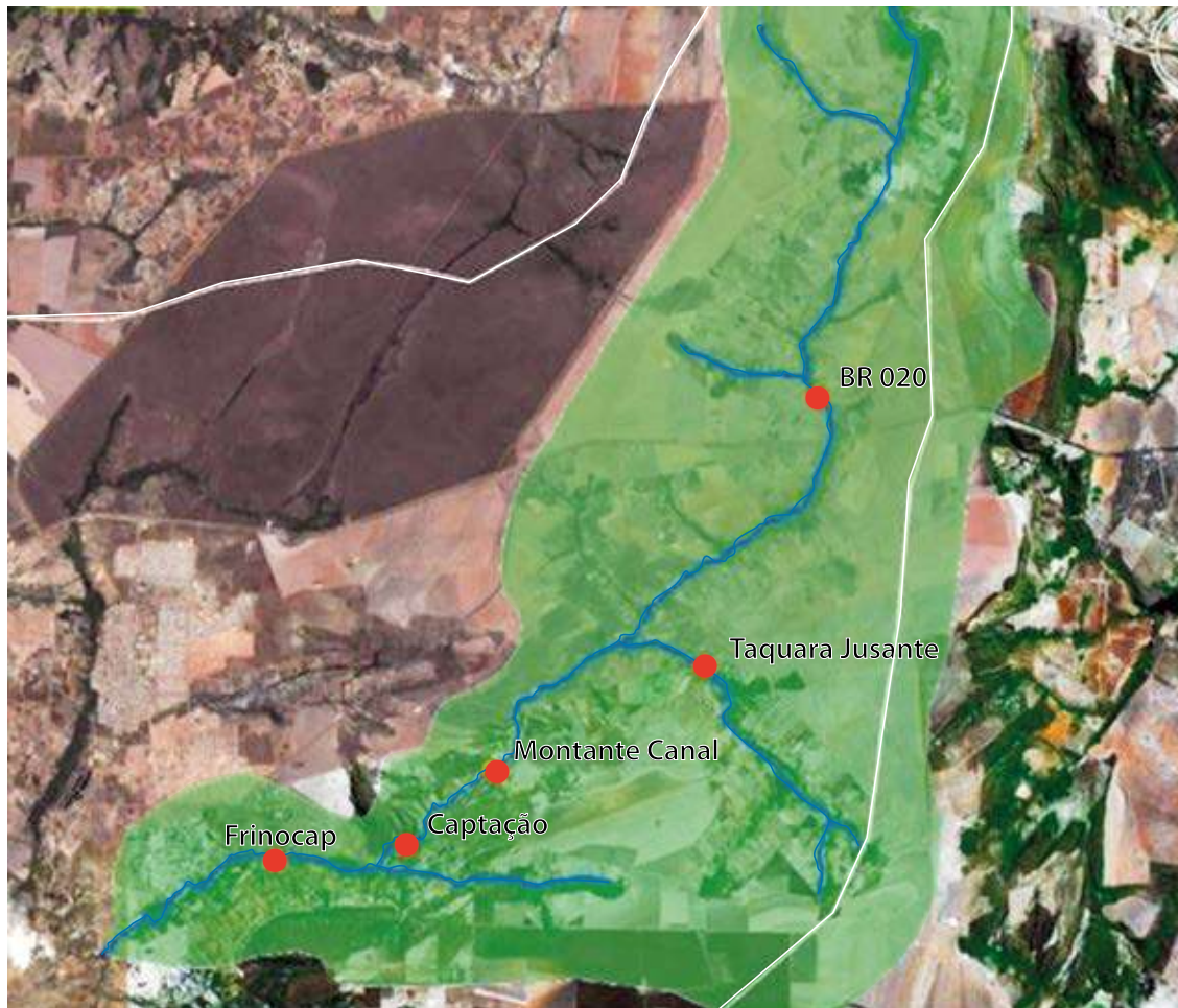
Figura 5. Localização das estações de monitoramento hidrológico na bacia hidrográfica do Pipiripau Estação Taquara-Jusante (Trecho 1); Estação Pipiripau BR-020 (Trecho 2); Estação Pipiripau Montante Canal (Trecho 3); Estação Pipiripau Montante Captação (Trecho 4); Estação Frinocap DF-130 (Trecho 5).
