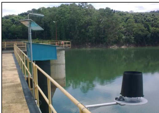
Figura 7 - Controle de nível - Represa Cachoeira – Instalação de sensor ultrassônico para variação do nível de água da represa com transmissão via telemetria em intervalo de até 10 minutos
