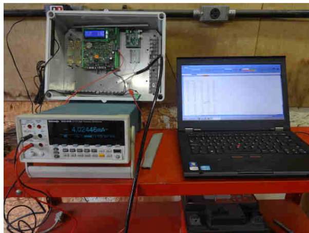
Figura 2 – Vista do Datalogger FCTH, multímetro e a planilha computadorizada.
