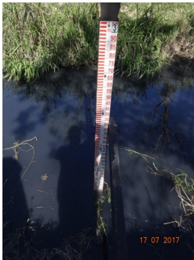
Figura 11 – Instalação de régua – Rio Parelheiros
