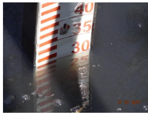
Figura 12 – Instalação de régua – Rio Parelheiros
