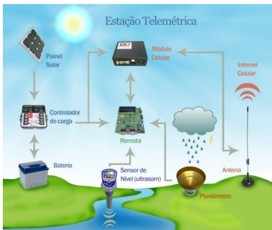
Figura 6 – Esquema para coleta e transmissão dos dados da estações telemétricas.
