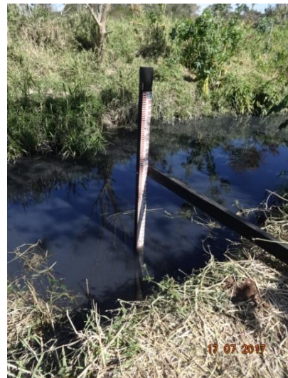
Figura 11 – Instalação de régua – Rio Parelheiros
