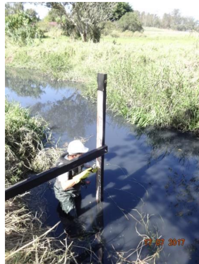
Figura 11 – Instalação de régua – Rio Parelheiros
