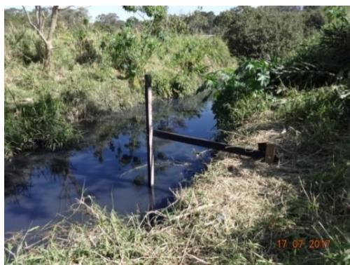
Figura 12 – Instalação de régua – Rio Parelheiros
