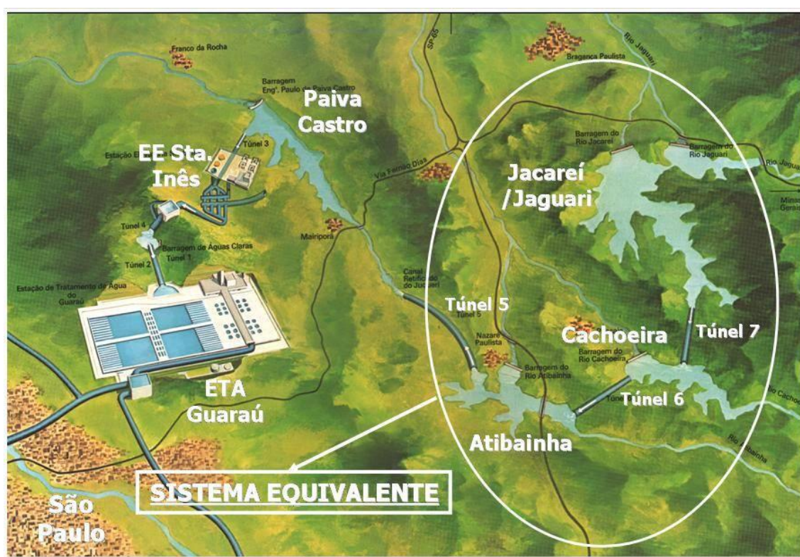
Figura 2.1 - Esquema simplificado do Sistema Cantareira.
