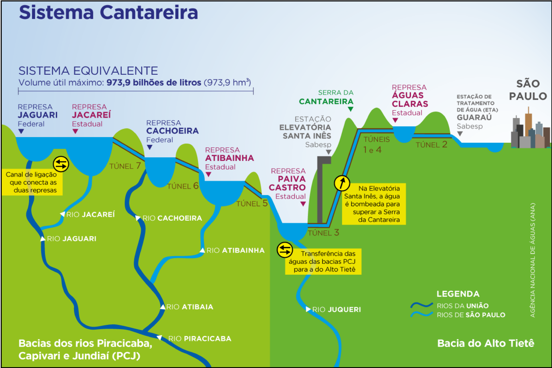
DIAGRAMA ESQUEMÁTICO DO SISTEMA CANTAREIRA
