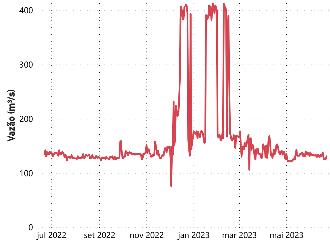
UHE Pereira Passos - Defluência (m³/s)
