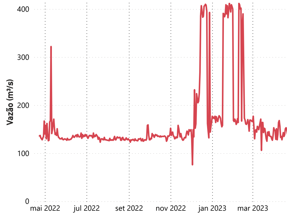
UHE Pereira Passos - Defluência (m³/s)
