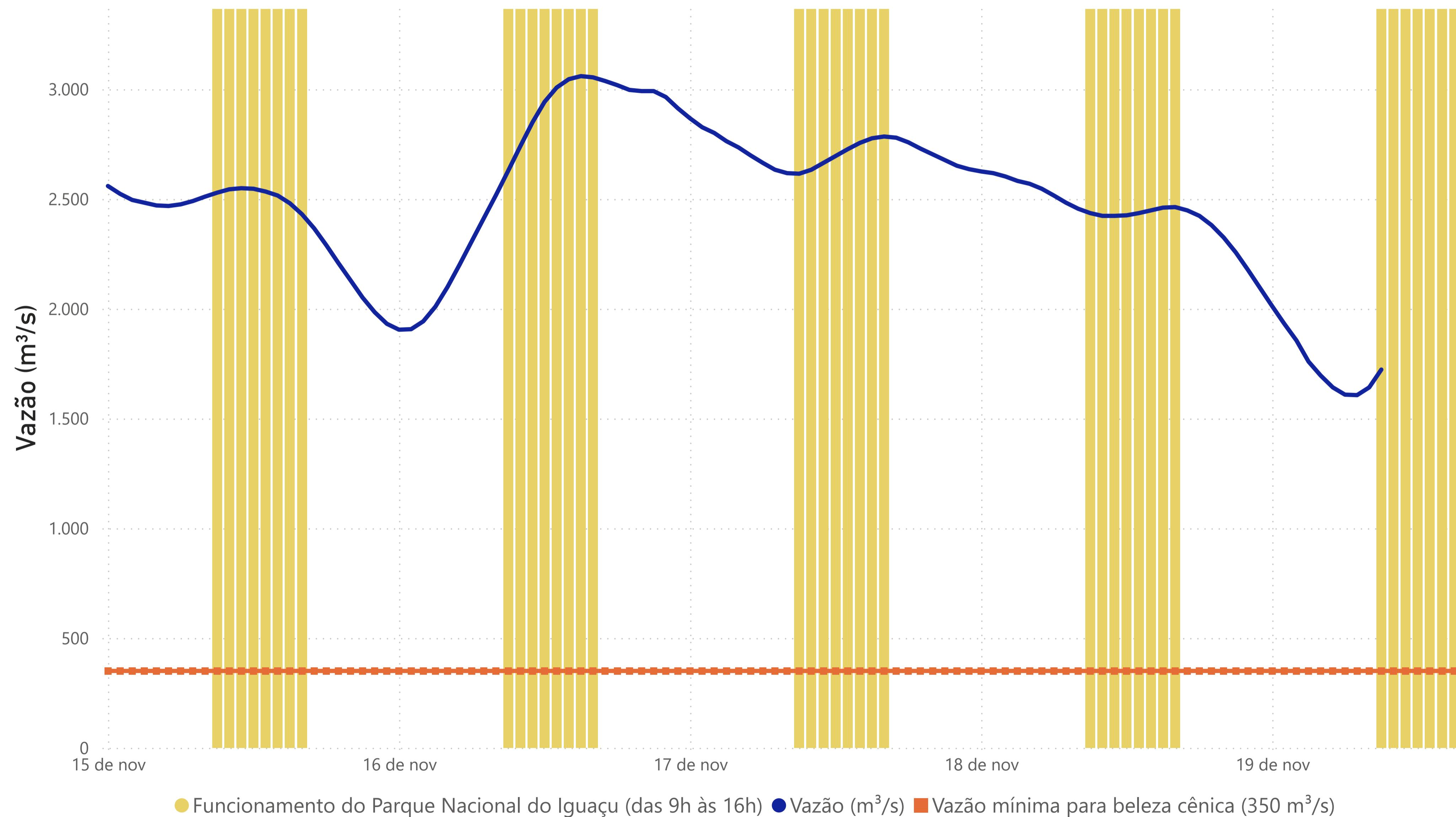
● Funcionamento do Parque Nacional do Iguaçu (das 9h às 16h) ● Vazão ( $\text{m}^3/\text{s}$ ) ■ Vazão mínima para beleza cênica ( $350 \text{ m}^3/\text{s}$ )
