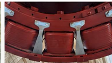
Aletas defletoras instaladas
