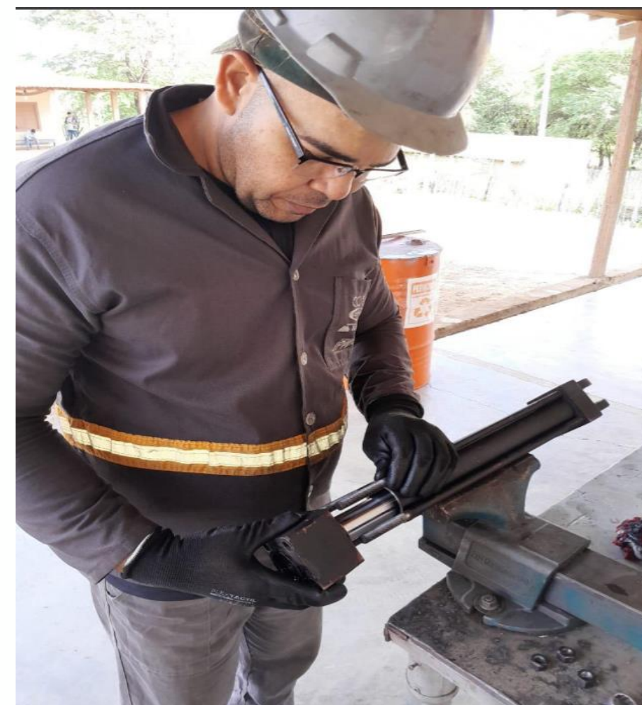
MANUNTENÇÃO CORRETIVA NOS PISTOES DAS COMPORTAS DAS ECs
